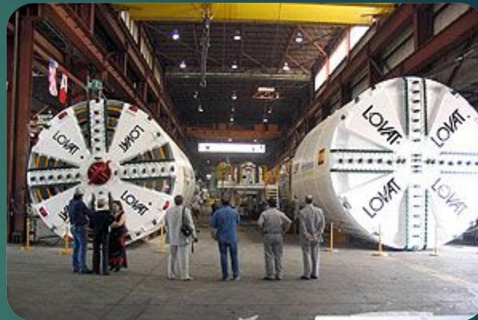
Основным элементом щитовой технологии строительства тоннелей является проходческий щит, представляющий собой передвижную временную крепь в виде цилиндрической оболочки, под прикрытием которого выполняют необходимые проходческие операции: разработку и погрузку грунта, транспортирование грунта за пределы щита, возведение обделки тоннеля. Выемку грунта осуществляют в головной части щита, возведение обделки в хвостовой.
