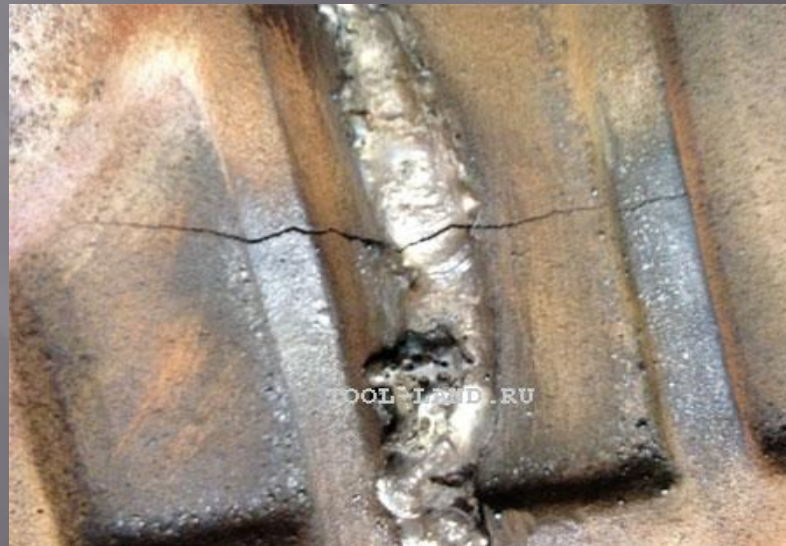
Рисунок 1 - Трещина в сваренной чугунной детали
