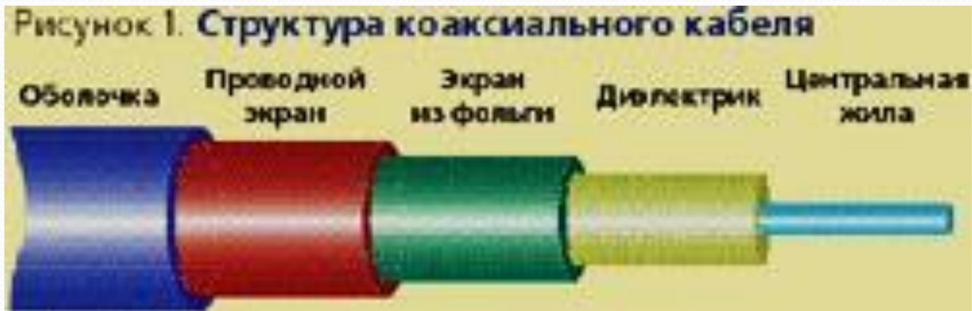
Внутри кабеля размещена **центральная жила** (проводник, сигнальный провод, линия, носитель сигнала, внутренний проводник), окруженная изоляционным материалом (**диэлектриком**).
