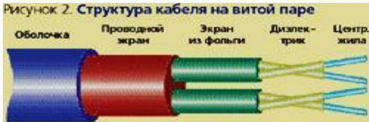
Материалы, используемые при изготовлении витой пары, аналогичны материалам, используемым при изготовлении коаксиального кабеля.
