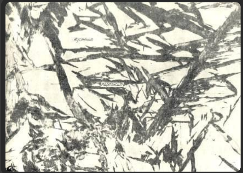
Микроструктура мартенсита ( с остаточным аустенитом )
