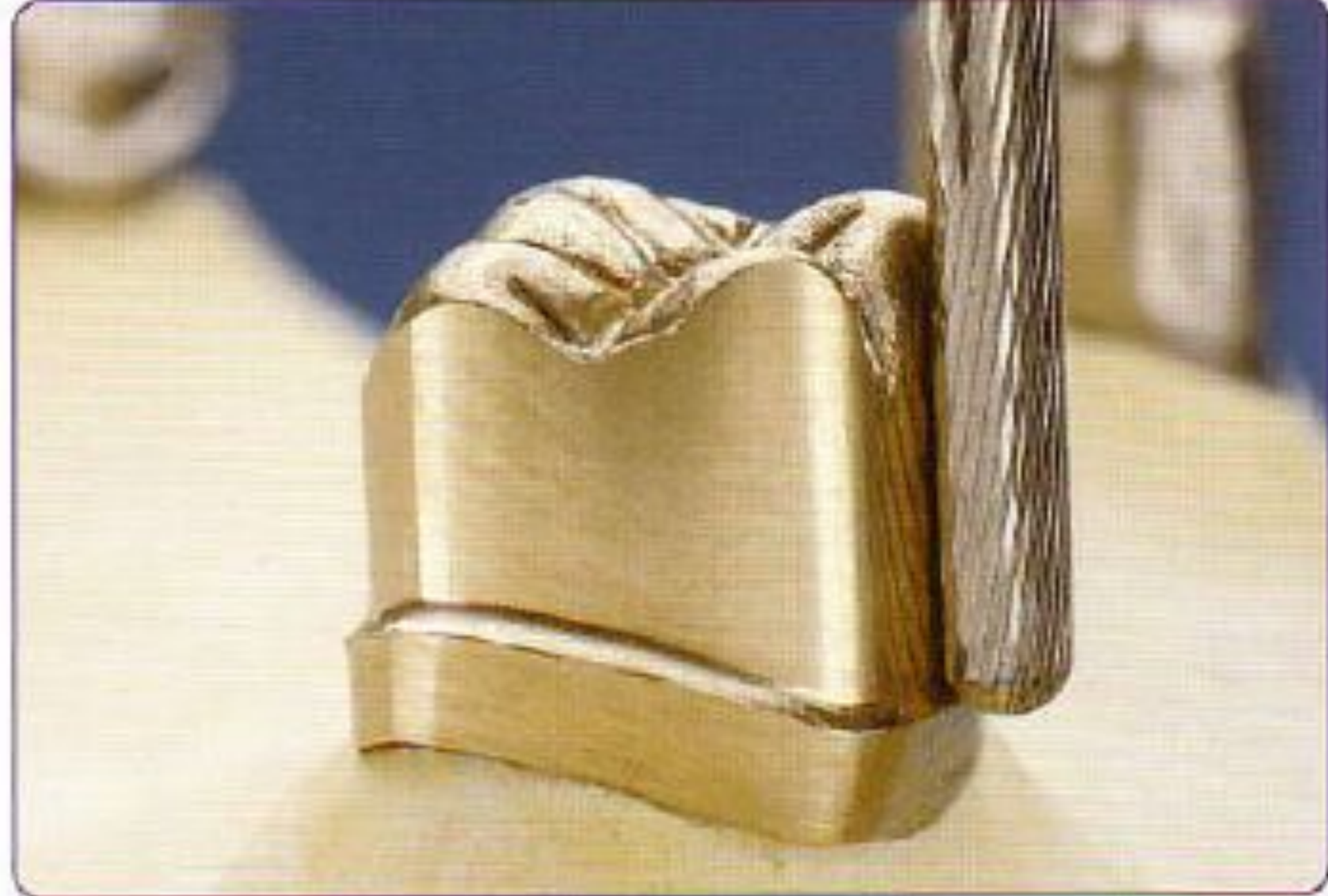
Параллельная фреза: фрезеровка пришеечного уступа
