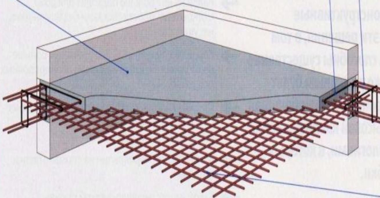
арматура влияет на несущую способность перекрытия – стержни могут быть уложены в двух направлениях или в одном (параллельно более короткой стороне); толщина перекрытия, армированного в двух направлениях, меньше, чем перекрытия такой же площади, армированного в одном направлении
