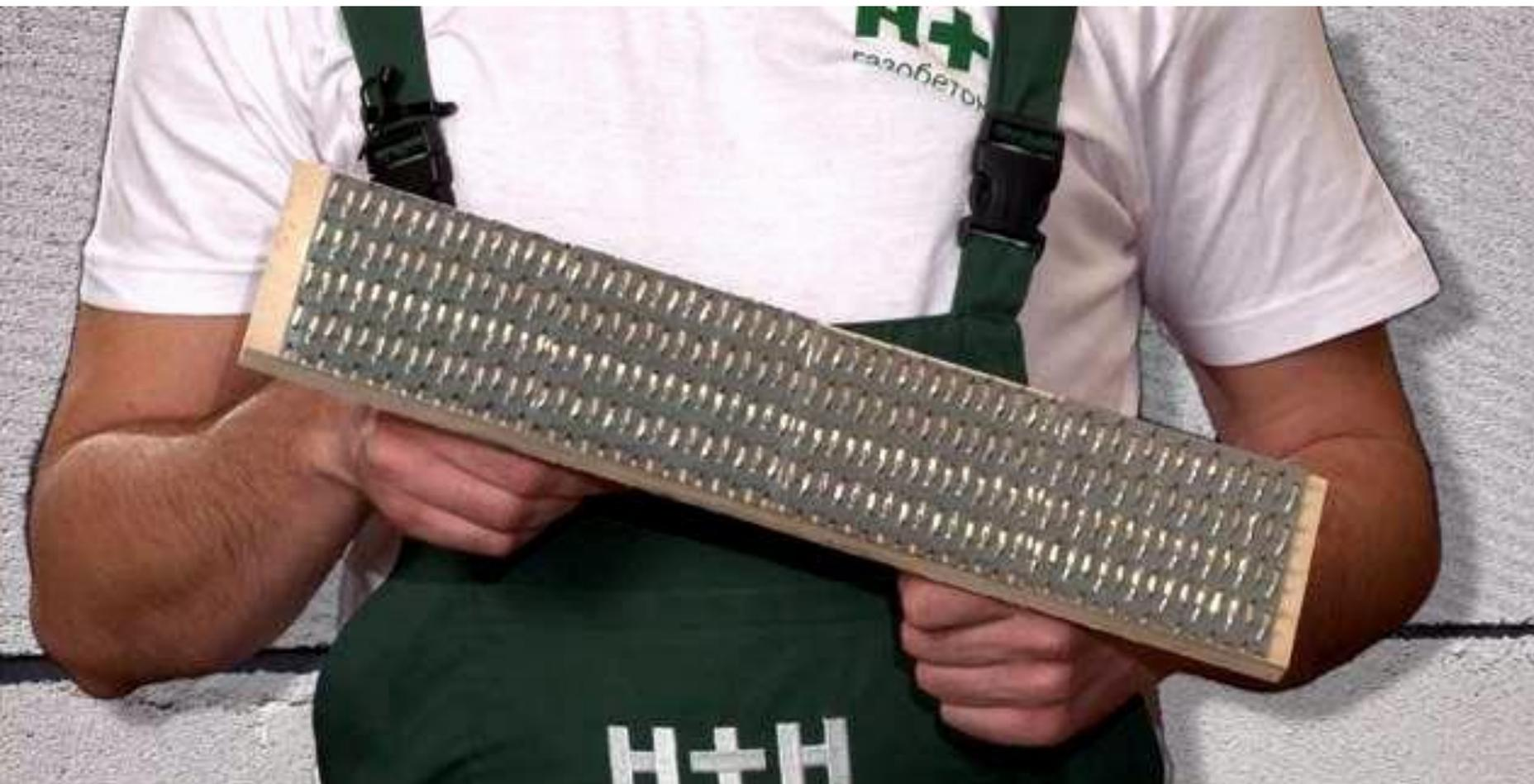
Терка для пенобетонных блоков
