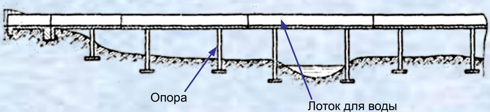
Акведуки используют для прокладки водоподающих сетей НАД участками со сложным рельефом, трубопроводами, дорогами и. т. д. Акведук представляет из себя мост, на верхней части которого проложен лоток для воды, сделанный из искусственных материалов. Рядом с лотком располагается пешеходный переход, при необходимости – оборудуется проезд для автотранспорта.
