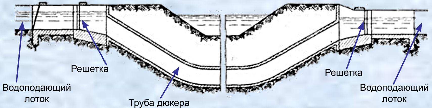
Дюкеры используют для прокладки водоподающих сетей в основном ПОД участками со сложным рельефом, инженерными коммуникациями, дорогами и т. д. В этом случае дюкер выполняется в виде заглубленной трубы большого диаметра, по которой течет вода.
