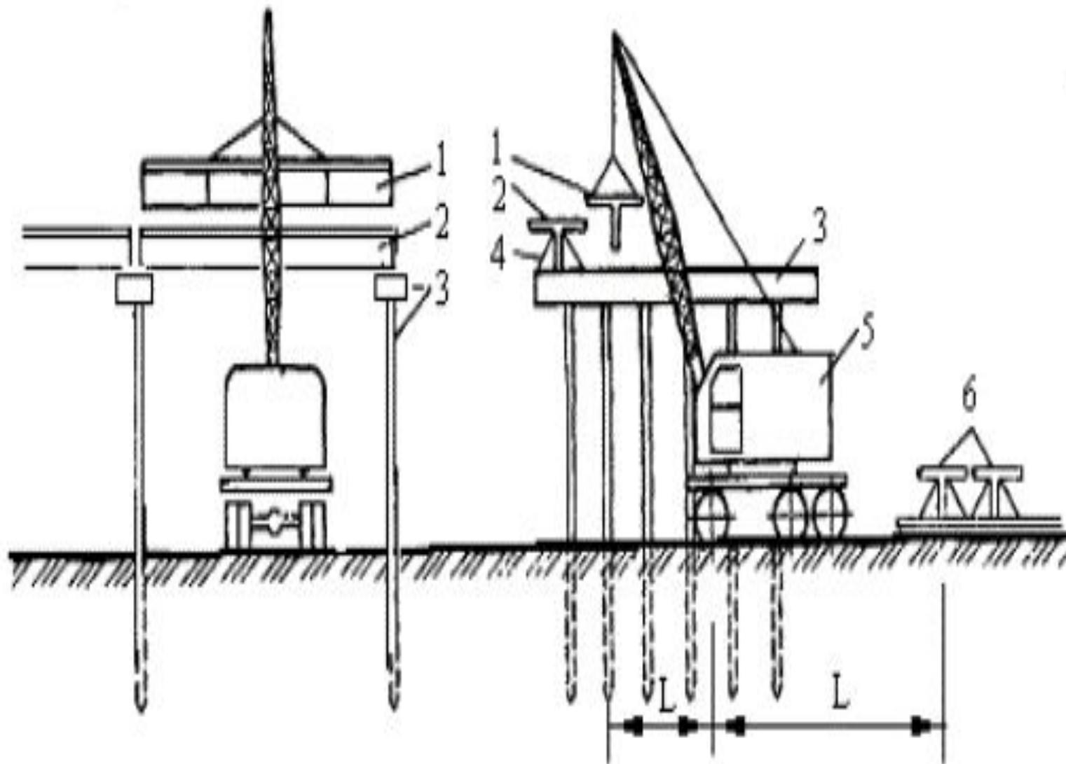
**Схема к монтажу пролетного строения краном сбоку:**
