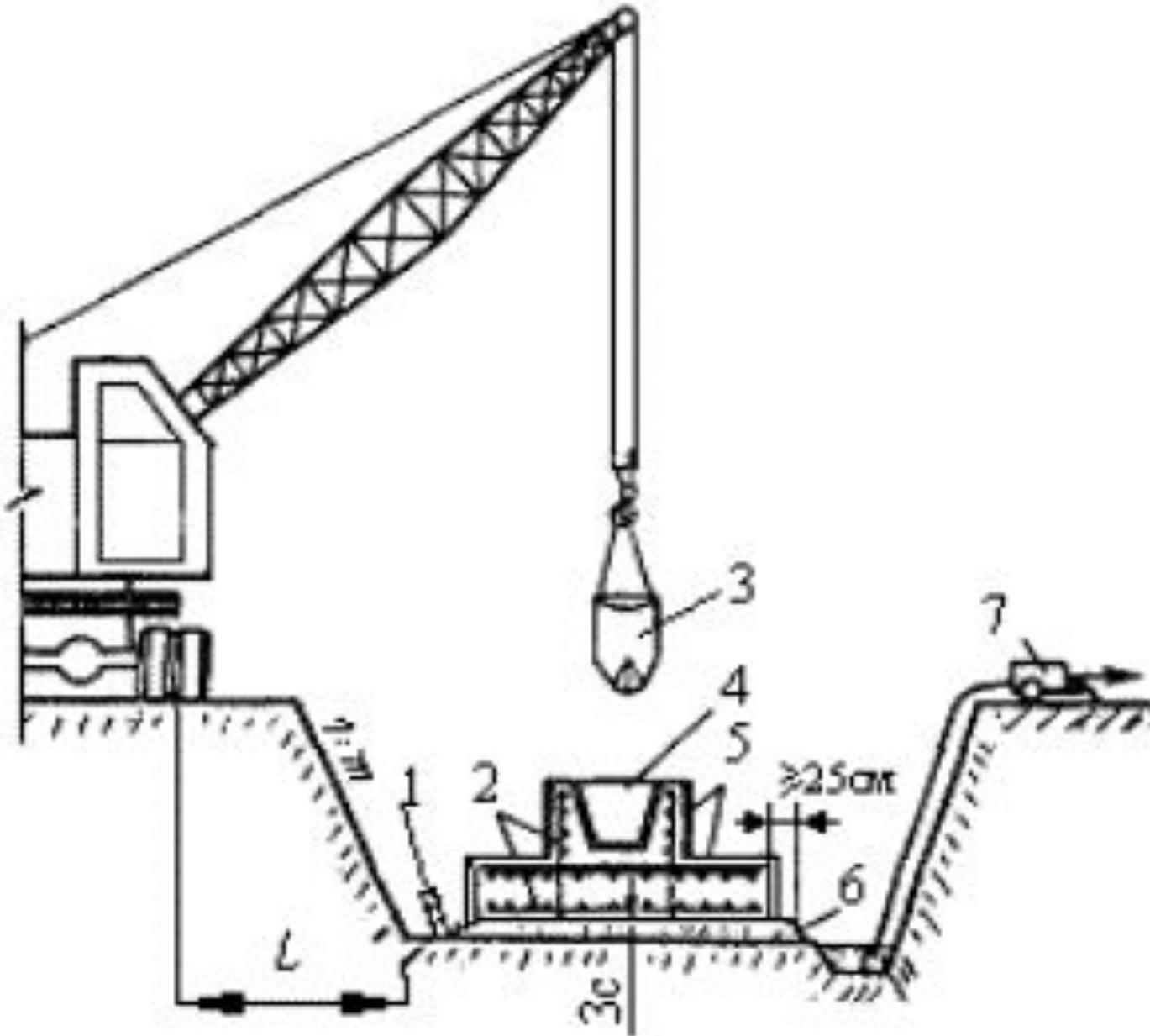
Рис. 4.2. Схема бетонирования фундамента в котловане:
