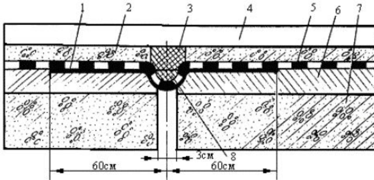
1 - компенсатор; 2 - защитный слой; 3 - битумная мастика; 4 - асфальтобетон; 5 - гидроизоляция; 6 - выравнивающий слой; 7 - изолируемая поверхность; 8 - микроасбест
