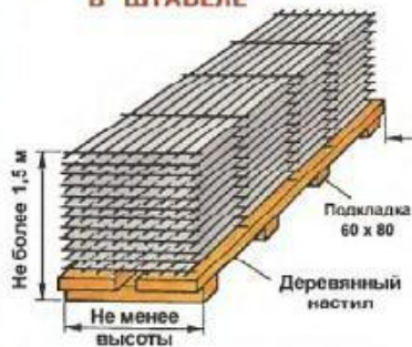
АРМАТУРНАЯ СЕТКА В ШТАБЕЛЕ
