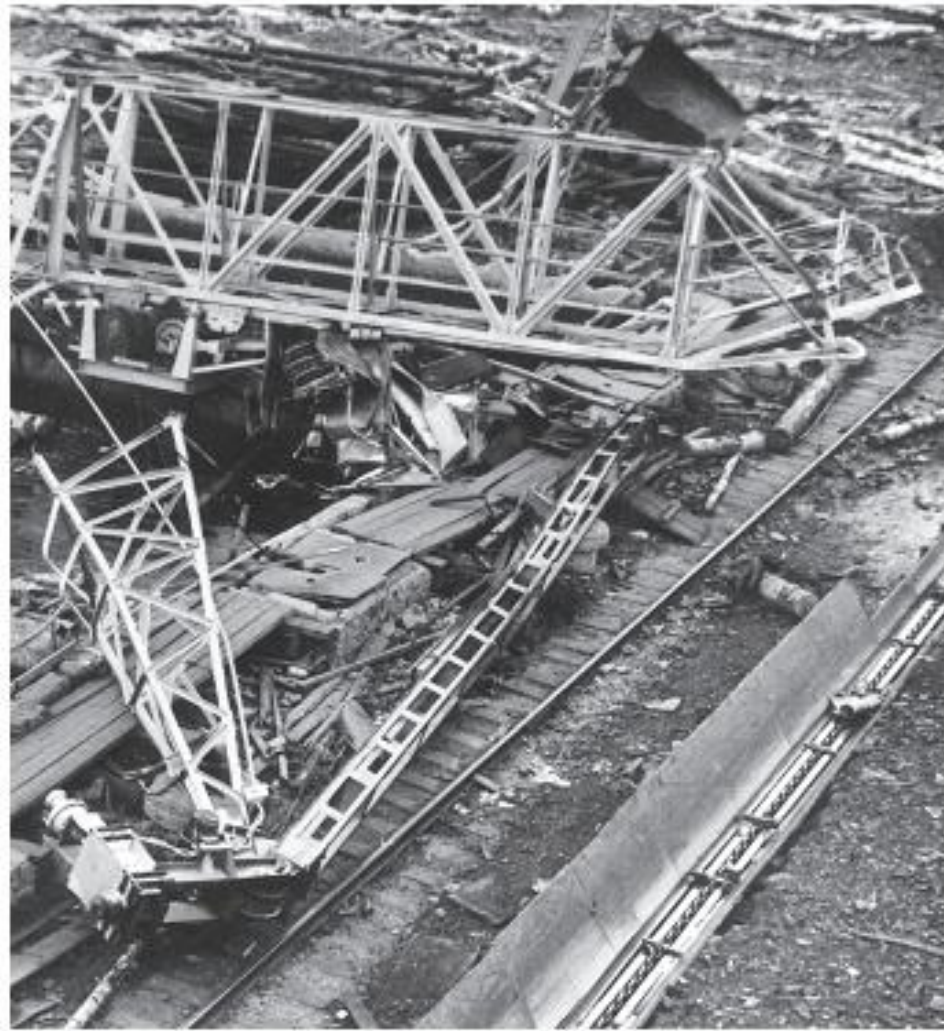
Рис. 11. Место аварии козлового крана ККС-10-32
