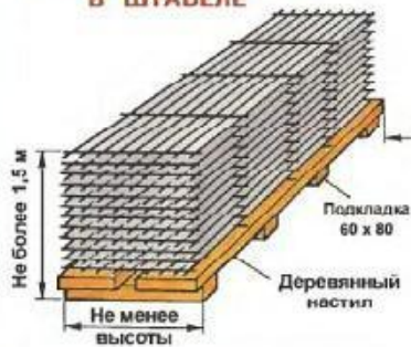
АРМАТУРНАЯ СЕТКА В ШТАБЕЛЕ
