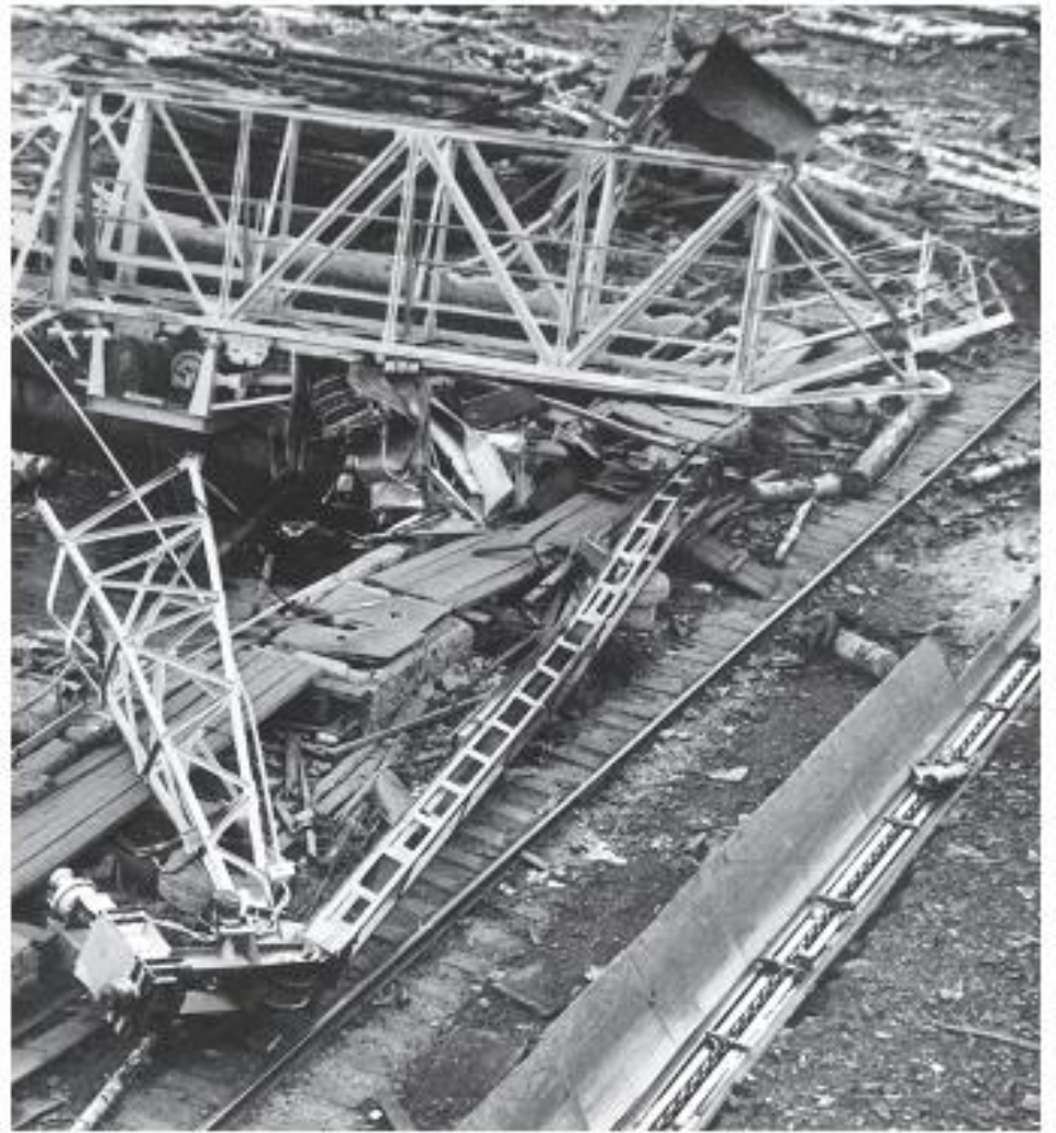
Рис. 11. Место аварии козлового крана ККС-10-32
