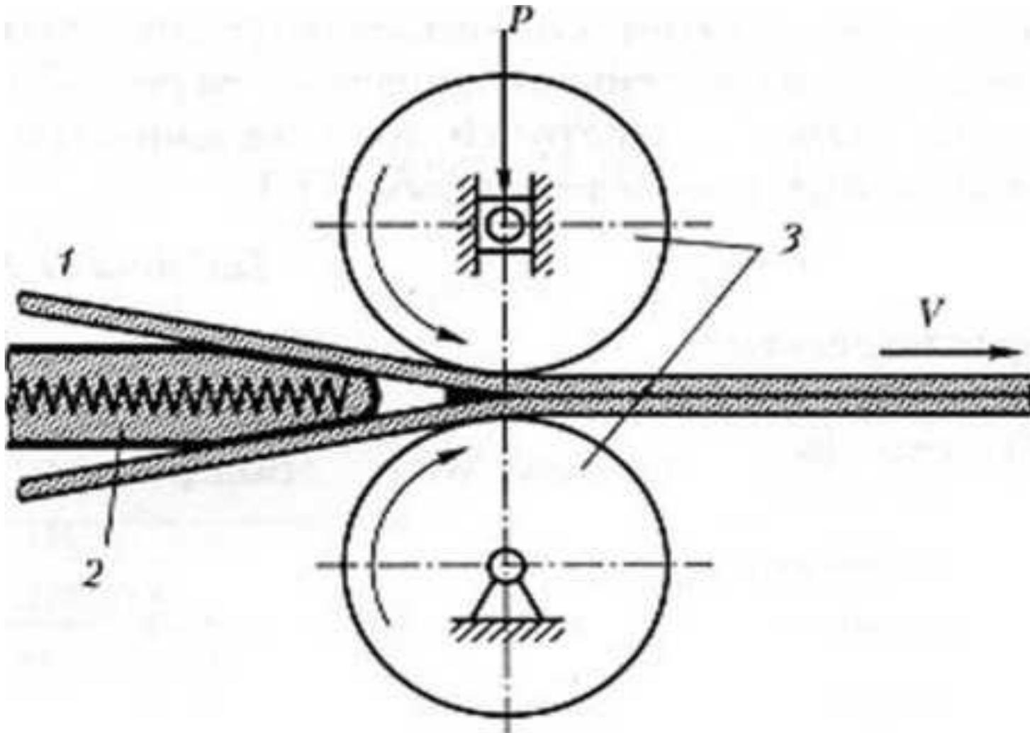
1- пленки: 2- клин-нагреватель: 3- тянущие валики, создающие сварное усилие  $P$
