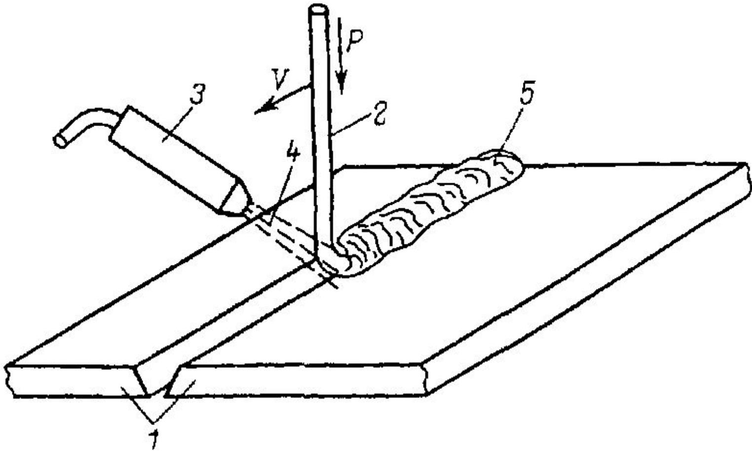
1 - детали с подготовленной поверхностью сварки; 2- пруток присадочного материала; 3 - сопло для подачи нагретого газа; 4 - поток горячего воздуха; 5 - сварной шов;  $P$  - давление на пруток;  $V$  - направление движения сварки
