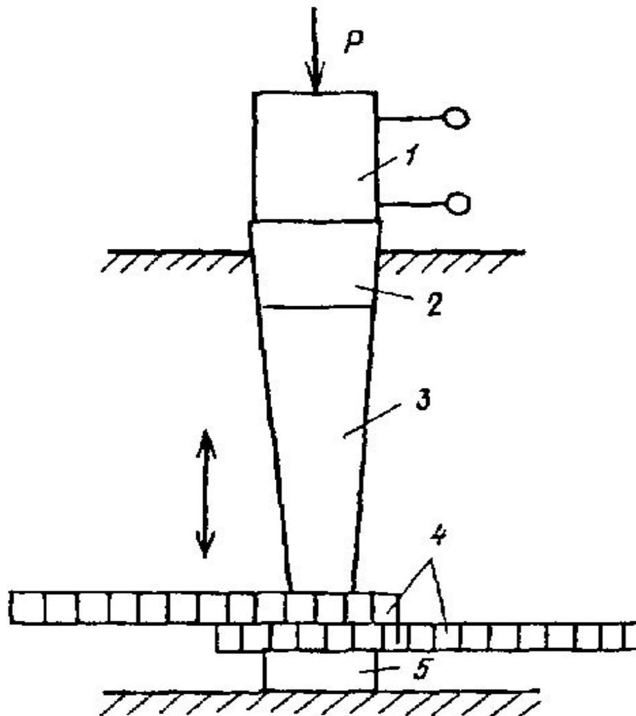
1 - излучатель УЗ; 2 - волновод; 3 - сварочный инструмент; 4 - свариваемые материалы; 5 - отражатель;  $P$  - давление сварки; стрелками показано направление высокочастотных механических колебаний
