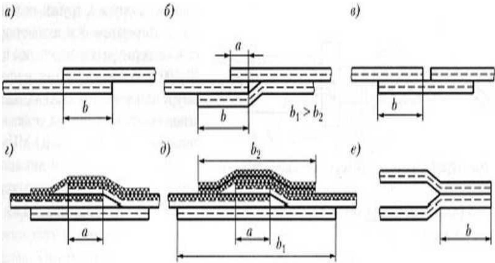
*a* - однослойные внахлестку; *б* - однослойные внахлестку с накладкой; *в* - однослойные встык с накладкой; *г* - армированные внахлестку с накладками из основной и армирующей пленок; *д* - армированные внахлестку с накладками из основной и двух слоев армирующих пленок; *е* - Т-образное с рантованным швом
