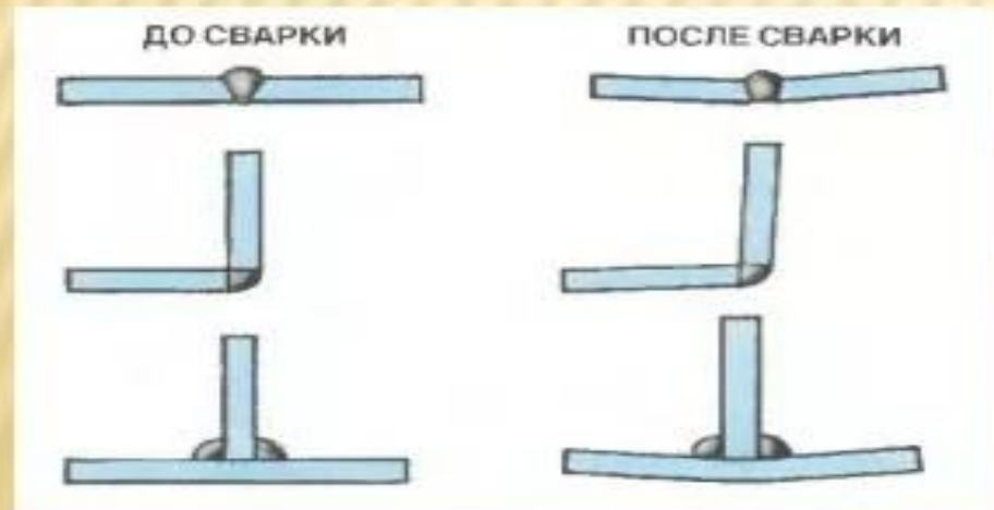
Деформации от поперечной усадки
