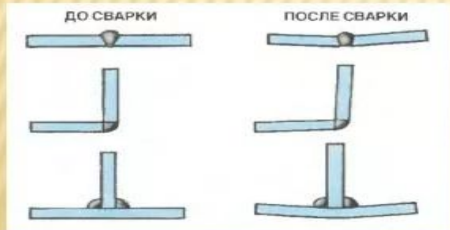
Деформации от поперечной усадки
