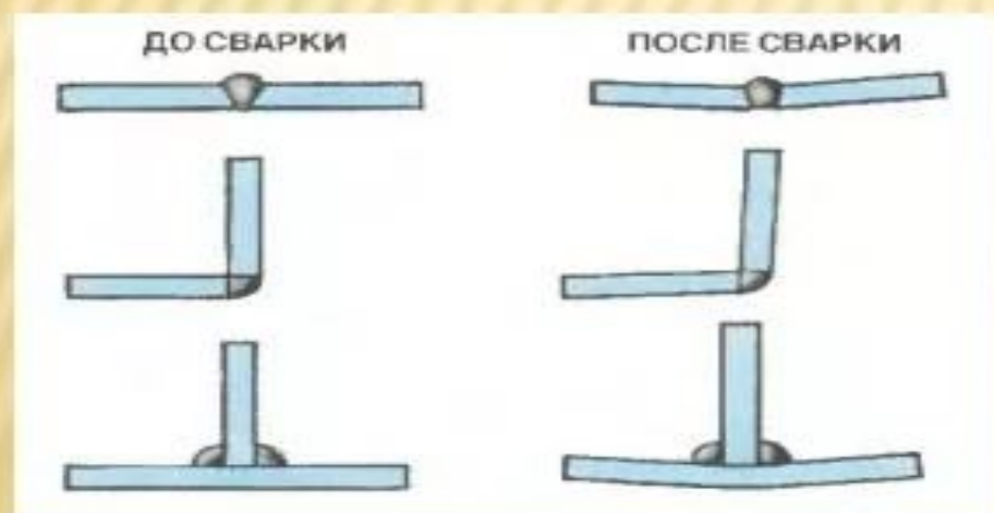
Деформации от поперечной усадки
