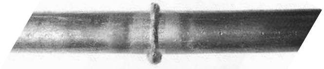
**Сварка прерывистым оплавлением** производится чередованием плотного и неплотного контакта деталей при включенном токе до тех пор, пока торцы их не нагреются до 800-900°C.
