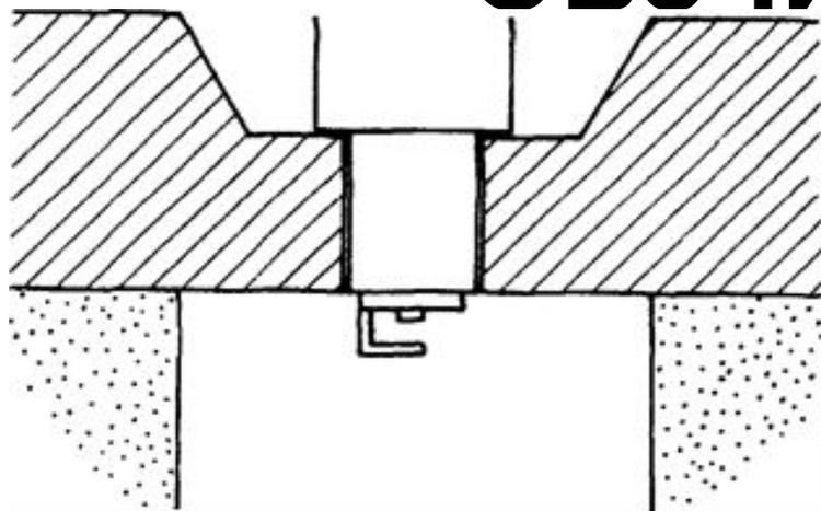
Рис. 9.9,б. Нормальная свеча
