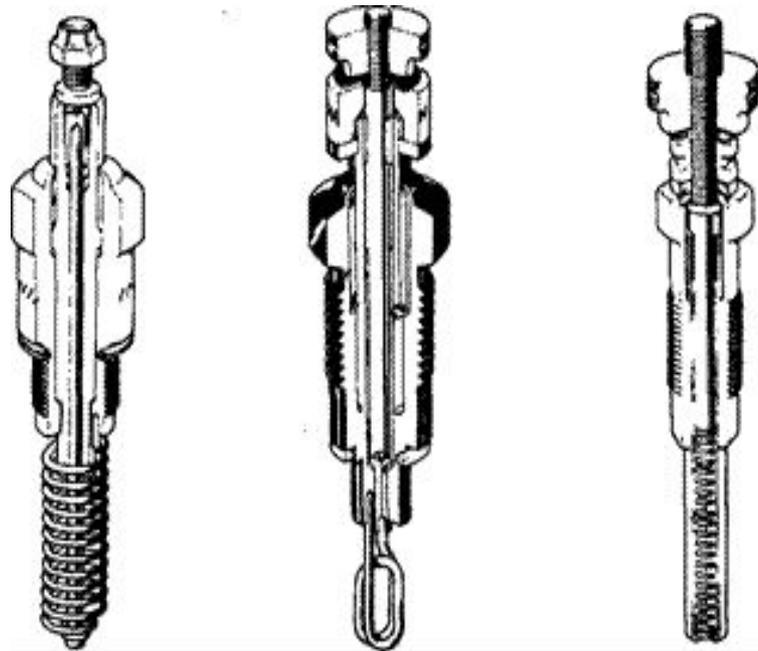
Запальные свечи (см. рис. 9.19) состоит из проволочной спирали, к которой подводится напряжение от аккумулятора. После пуска двигателя цепь питания запальных свечей автоматически прерывается.
