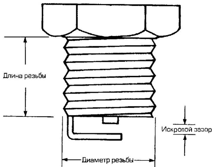
Рис. 9.8. Основные размеры свечи зажигания
