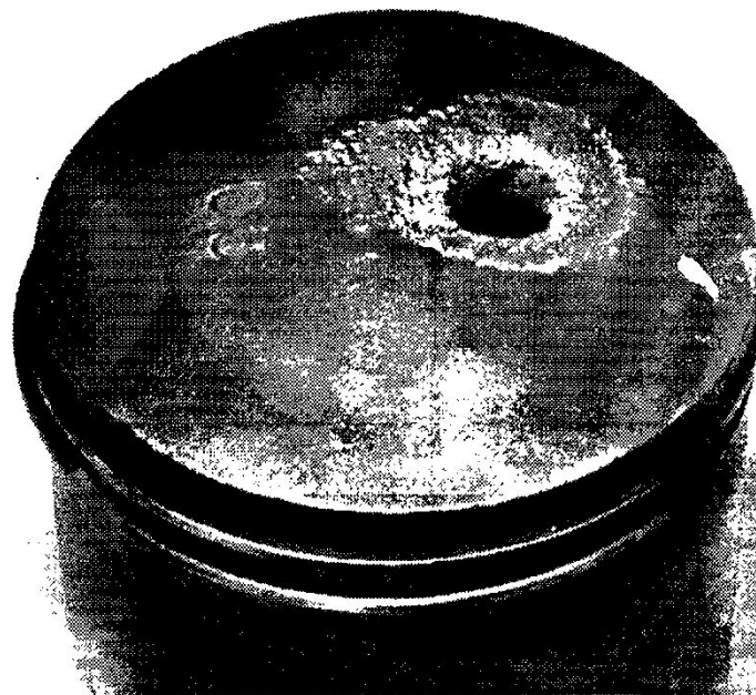
Рис. 9.5. Прогар днище поршня при "каильном" зажигании
