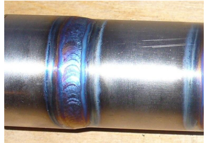
Сварной шов титановой трубы
