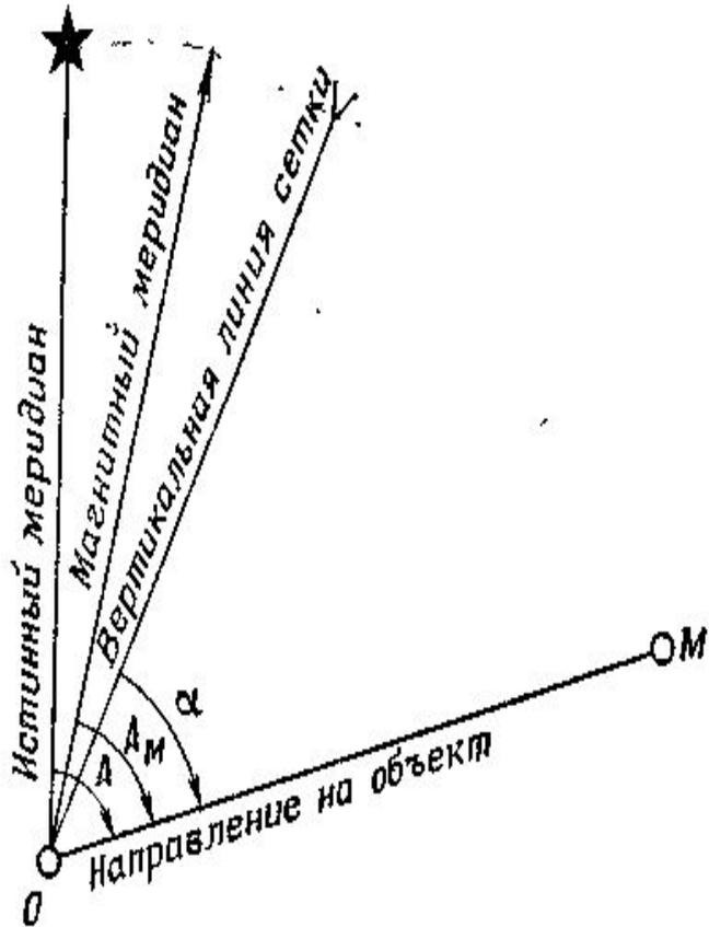
Дирекционным углом какого-либо направления называется угол, измеряемый на карте по ходу часовой стрелки от 0 до 360 градусов между северным направлением вертикальной километровой линии и направлением на определяемую точку.
