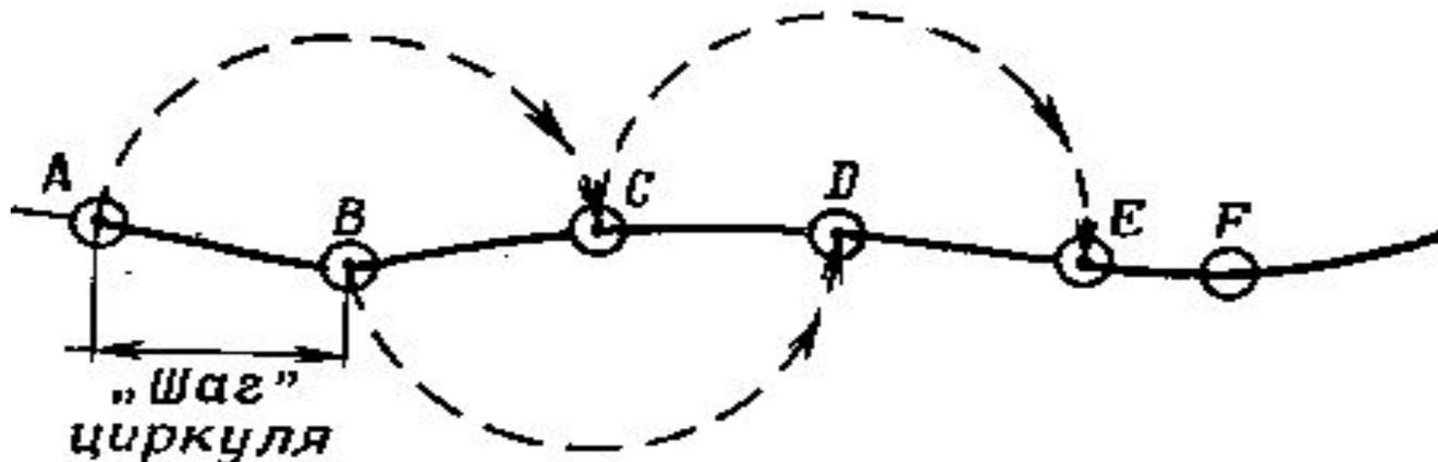
Величину "шага" выбирают в зависимости от извилистости линии: от 4-5 см - при измерении кривых с плавными закруглениями, до 1-2 см - при измерении линий с большим числом резких поворотов. Для измерения кривых и извилистых линий используют также специальный прибор - **курвиметр**.
