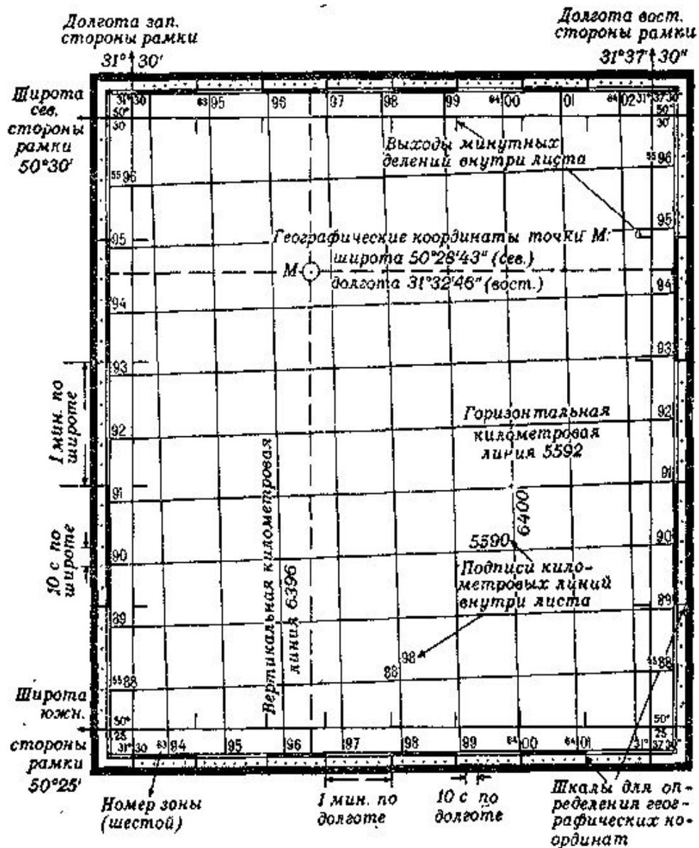
Чтобы определить широту какой-либо точки, например точки М, по карте масштабов 1:25000—1:200000, надо приложить линейку к этой точке так, чтобы она проходила через одноименные деления (или их доли) на шкалах западной и восточной сторон рамки, и по одной из этих шкал сделать отсчет.
