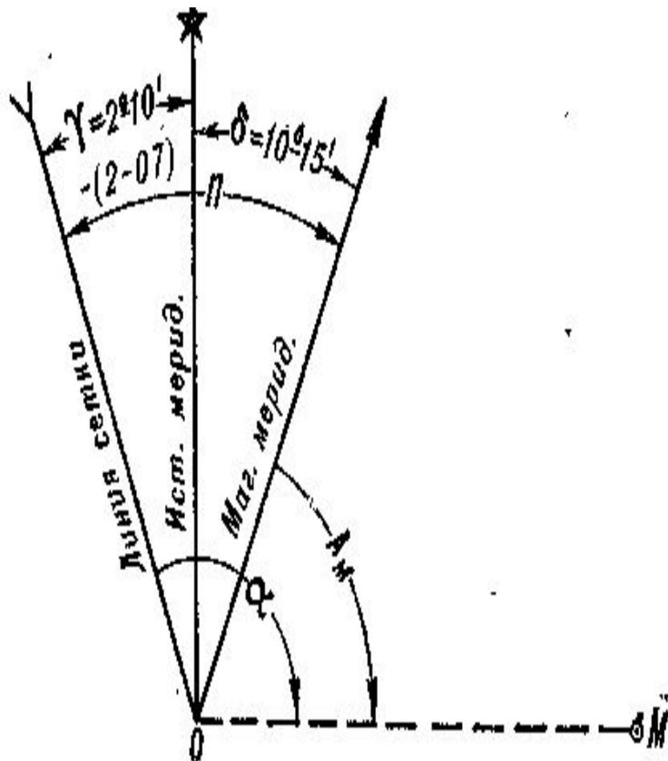
**Сближение меридианов** ( $\gamma$ ) — угол между истинным меридианом точки и вертикальной километровой линией — зависит от удаления этой точки от осевого меридиана зоны и может иметь значение от 0 до  $\pm 3^{\circ}$ . На схеме показывают среднее для данного листа карты сближение меридианов.
