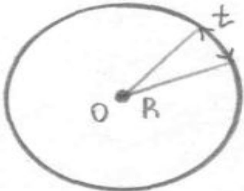
Тысячная - это центральный угол, опирающийся на дугу, равную одной тысячной длины радиуса. Поправки направления на карте указываются как в градусах, так и в делениях угломера. Так же с помощью формулы тысячной обычно измеряют с достаточной точностью расстояния на местности или в других случаях.
