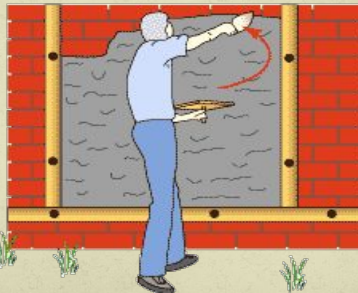
набрасывание слоя бетона
