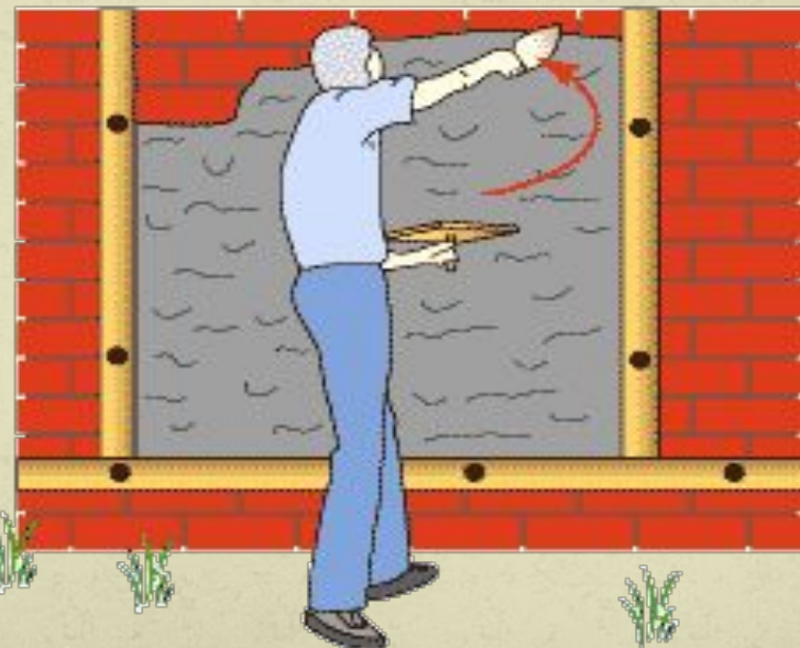
набрасывание слоя бетона
