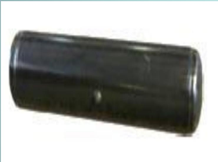
Предназначен для питания тормозного цилиндра сжатым воздухом.
