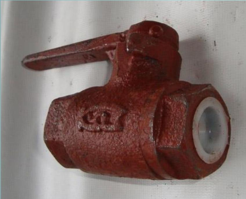
Устанавливается на ответвлении трубы , идущей от магистрали к воздухораспределителю, **служит для отключения тормоза одного вагона в случае неисправности.**
