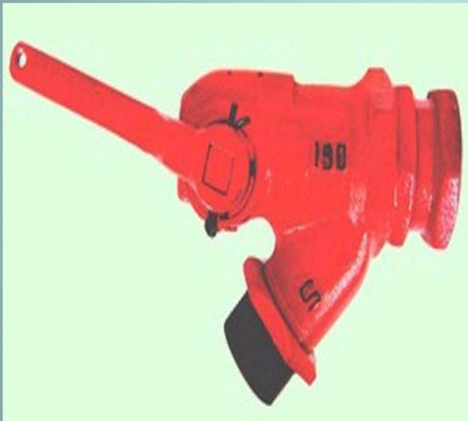
Установлены на воздушной магистрали с обоих концов вагона и служат **для разобщения и сообщения тормозной магистрали поезда** перед расцеплением вагонов и для соединения тормозных магистралей каждого вагона в единую тормозную магистраль поезда. На наружном конце хвостового (головного) вагона поезда он должен находиться в закрытом положении.
