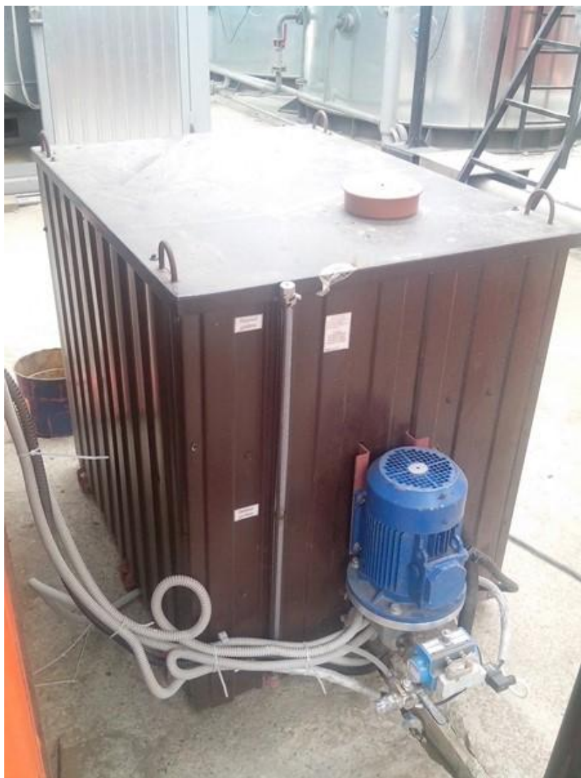
Установка автоматизированного дозирования УАД-1000М (Котласский химический завод)
