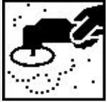
Начальная обработка поврежденного места производится шлифбумагой зернистостью Р80. Завершается шлифование поврежденного места шлифбумагой зернистостью Р120 - 150, с плавным переходом к неповрежденной области шлифбумагой Р240-Р320, для сглаживания границ вокруг неремонтируемого участка.
