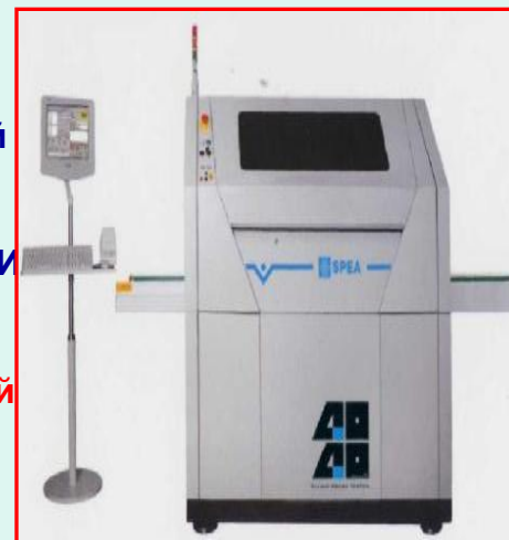
Система электрического контроля SPEA 4040 Электрический контроль печатных лат и печатных узлов летающими пробами (Автоматизированный процесс)
