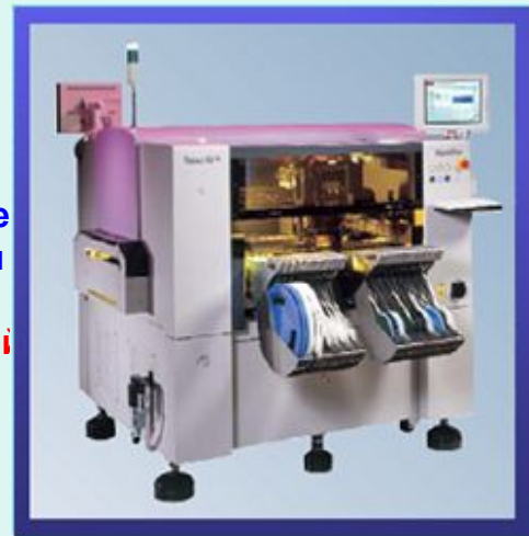
Прецизионный автома для установки компонентов на печатные платы Opal-X(I) (Автоматизированный процесс)
