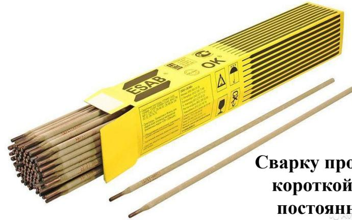
Сварку производят на короткой дуге на постоянном токе, обратной полярности, во всех положениях кроме вертикального сверху-вниз.
