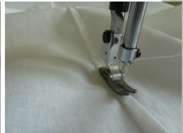
Выполнение второй строчки запошивочного шва
