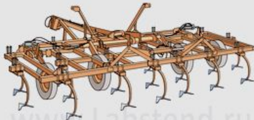
Культиватор тяжелый секционный КТС-10-1 (гидрофицированный, прицепной)
