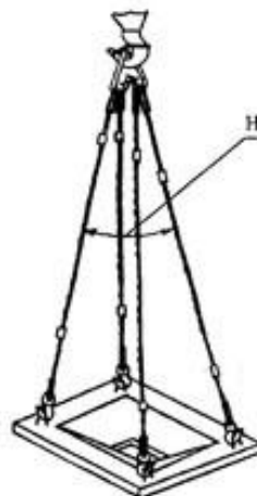
Строп 4СК1-3,2+4СК1-10,0 Q=3,2÷10,0 тс при монтаже
