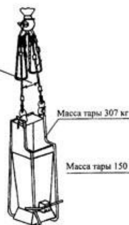
Строп 4СК1-10,0 Q=10,0 тс при подаче бункера(бадьи) с бетонной смесью V=1 м³ Р=3,0 т
