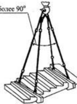
Строп 4 СК1-3,2+4 СК1-10,0 Q = 3,2 + 10,0 тс при подаче ящика с цементным раствором емкостью 0,28 \text{ м}^3 P = 0,65 т
