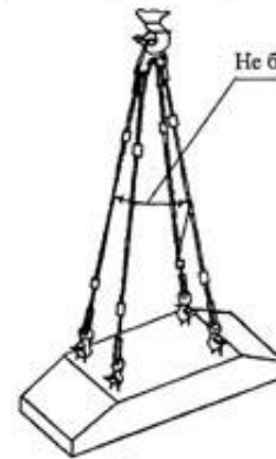
Строп 4СК1-3,2; 4СК1-5,0; 4СК1-10,0 Q=3,2+10,0 тс при монтаже фундаментных блоков P=0,88-7,32 т
