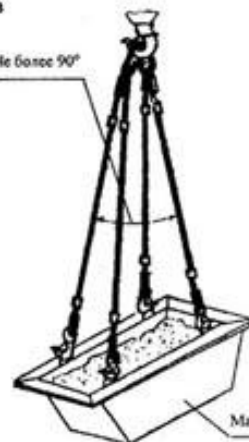
Строп 4 СК1-3,2+4 СК1-10,0 Q = 3,2 + 10,0 тс при подаче ящика с цементным раствором емкостью 0,28 \text{ м}^3 P = 0,65 т
