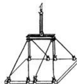
Траверса Т-1 Q=8,0 тс при монтаже плит
