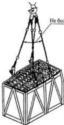
Строп 4СК1-5,0; 4СК1-10,0 Q=5,0÷10,0 тс при разгрузке контейнера для рулонных материалов
