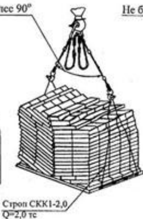
Строп 4СК1-3,2+4СК1-10,0 Q=3,2÷10,0 тс при разгрузке с автотранспорта кирпича на поддонах Р=1,6 т
