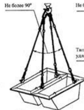
Строп 4 СК1-3,2+4 СК1-10,0 Q = 3,2 + 10,0 тс при подаче пустой тары P = 54 \times 2 = 108 кг
