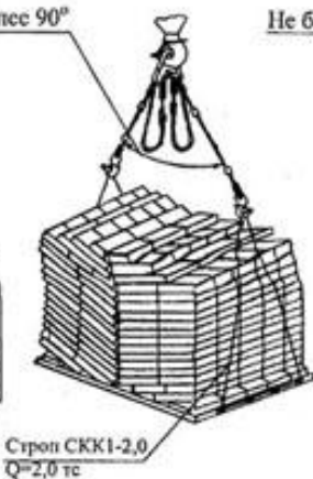
Строп 4СК1-3,2+4СК1-10,0 Q=3,2÷10,0 тс при разгрузке с автотранспорта кирпича на поддонах Р=1,6 т
