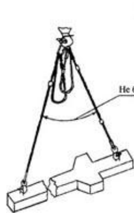
Строп 4СК1-3,2 4СК1-5,0 4СК1-10,0 4СК1-10,0 4СК1-10,0 (2СК-5,0) (2СК-5,0) (2СК-5,0) Q=5,0+10,0 тс Q=3,2+10,0 тс Q=5,0+10,0 тс при разгрузке колонн
