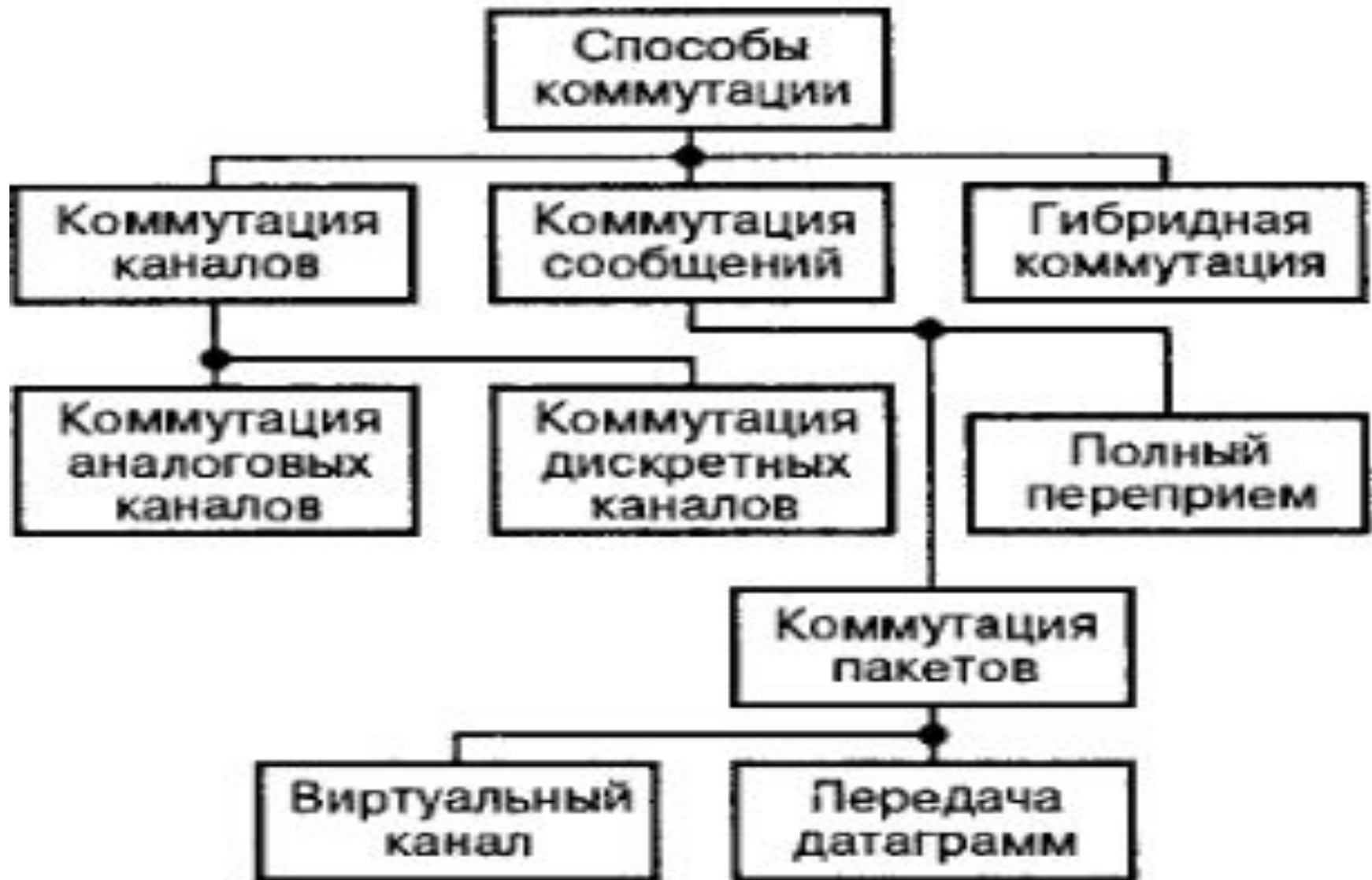
Рис. Классификация способов коммутации
