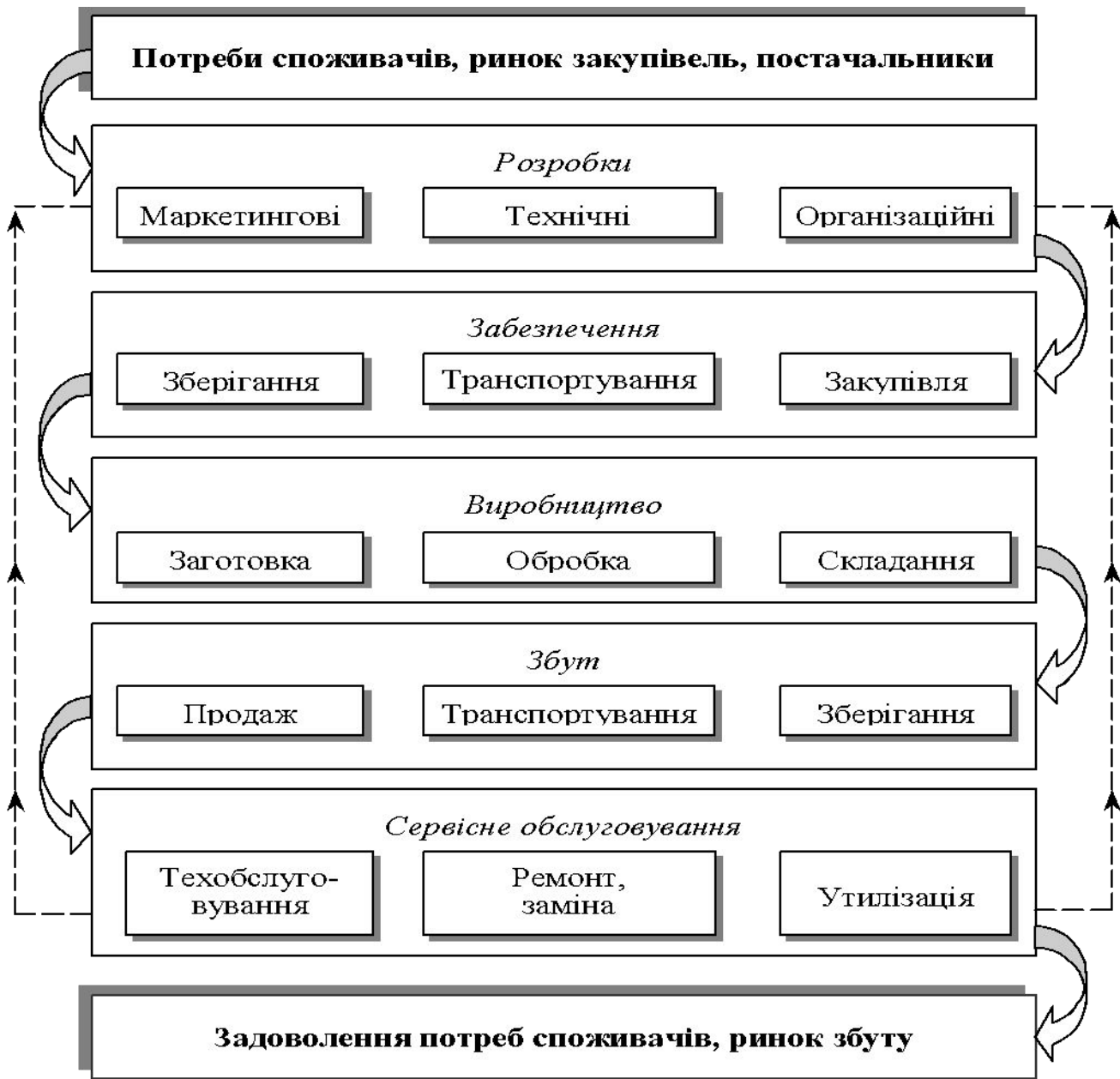
Рис. 1. Загальна схема логістичного ланцюга забезпечення процесу виробництва і обігу продукції та зворотного процесу оргпроекування
