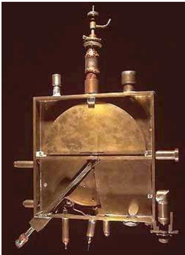
Рис. 1. Первая работающая модель циклотрона
