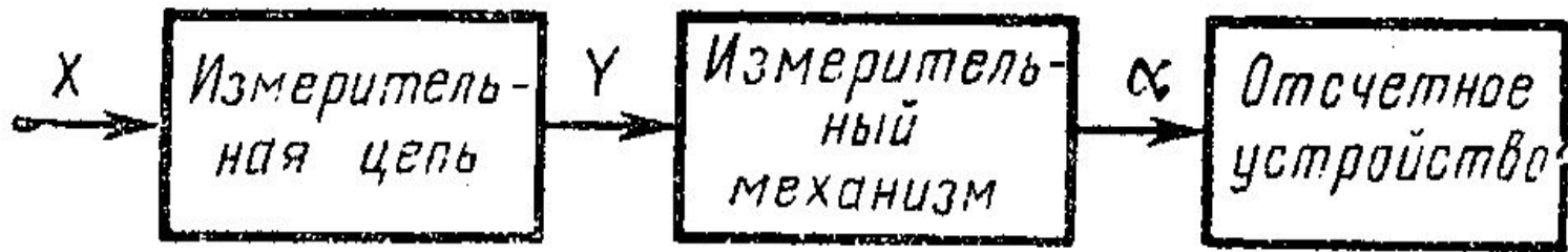
Рис. 1 Структурная схема электромеханического прибора
