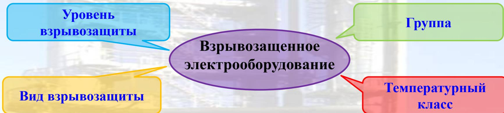
**Уровень взрывозащиты электрооборудования** – это степень его взрывозащиты (надежности) при установленных нормативными документами условиях (или по другому – это степень надежности электрооборудования).
