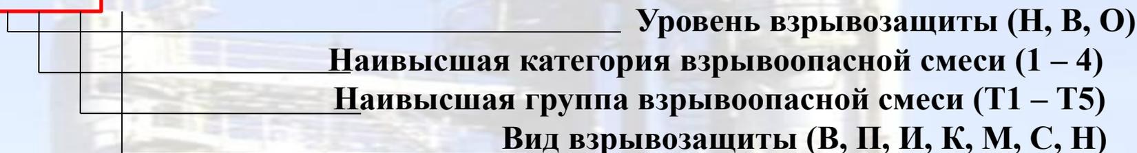
**Полная расшифровка:** взрывобезопасное, во взрывонепроницаемом исполнении, соответствует категориям смеси - 1, 2, 3, группам Т1, Т2, Т3, Т4.
