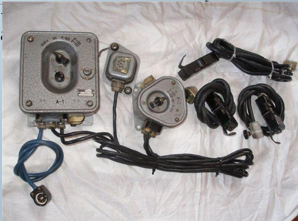
**Аппарат-переключатель водителя (ПВ)** предназначен для включения механика-водителя в систему внутренней или внешней связи.
