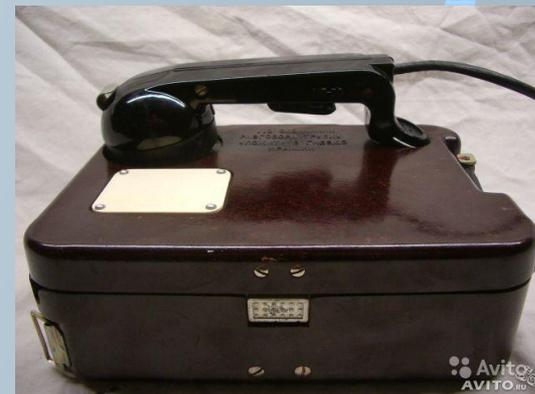
**ТА-57** — военно-полевой телефонный аппарат универсального типа с системой индукторного вызова производства СССР/РФ, выпускается с 1957 года.
