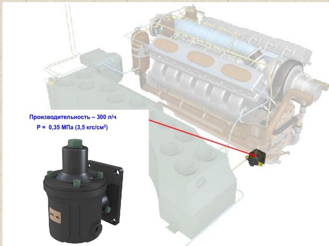
Для подачи топлива в систему питания двигателя входят:
