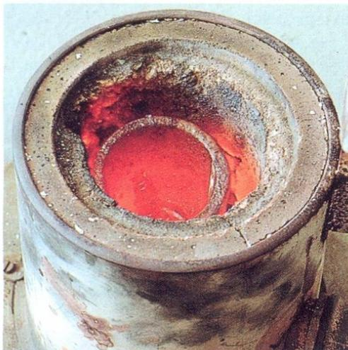
▲ 1. Металлы можно сплавлять в печах различных типов. Здесь показана газовая печь с поддувом электро-вентиляторами и внутренним графитовым тиглем.
