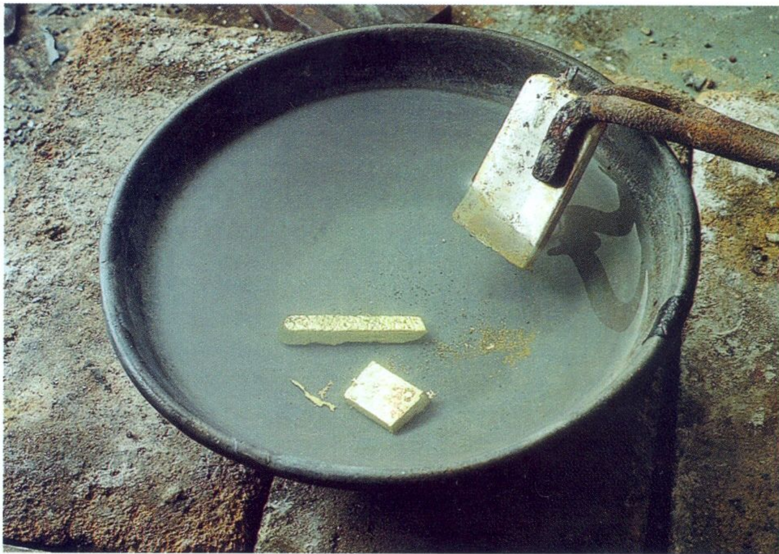
▲ Слитки в отбеливающем растворе серной кислоты. Свинцовые емкости стойки к нагреванию и ударопрочны.
