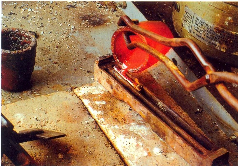
◀ 3. Для изготовления проволоки металл заливают в специальную изложницу. Важно, чтобы в момент заливки металла изложница была горячей. Если это не так, металл вследствие термального шока будет выплескиваться.
