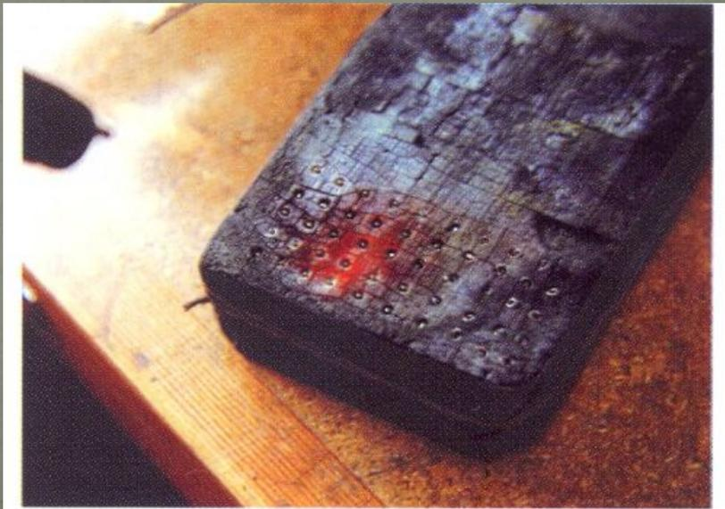
При плавке драгоценных металлов и сплавов для предохранения расплавов от окисления, насыщения кислородом и другими газами из окружающей среды, а также для верхней теплоизоляции расплавов (для сокращения расходов, теплоты на плавку) применяют следующие защитные покровы: *древесный уголь, буру, борную кислоту, хлористый кальций, хлористый натрий, хлористый калий, хлористый барий.*
