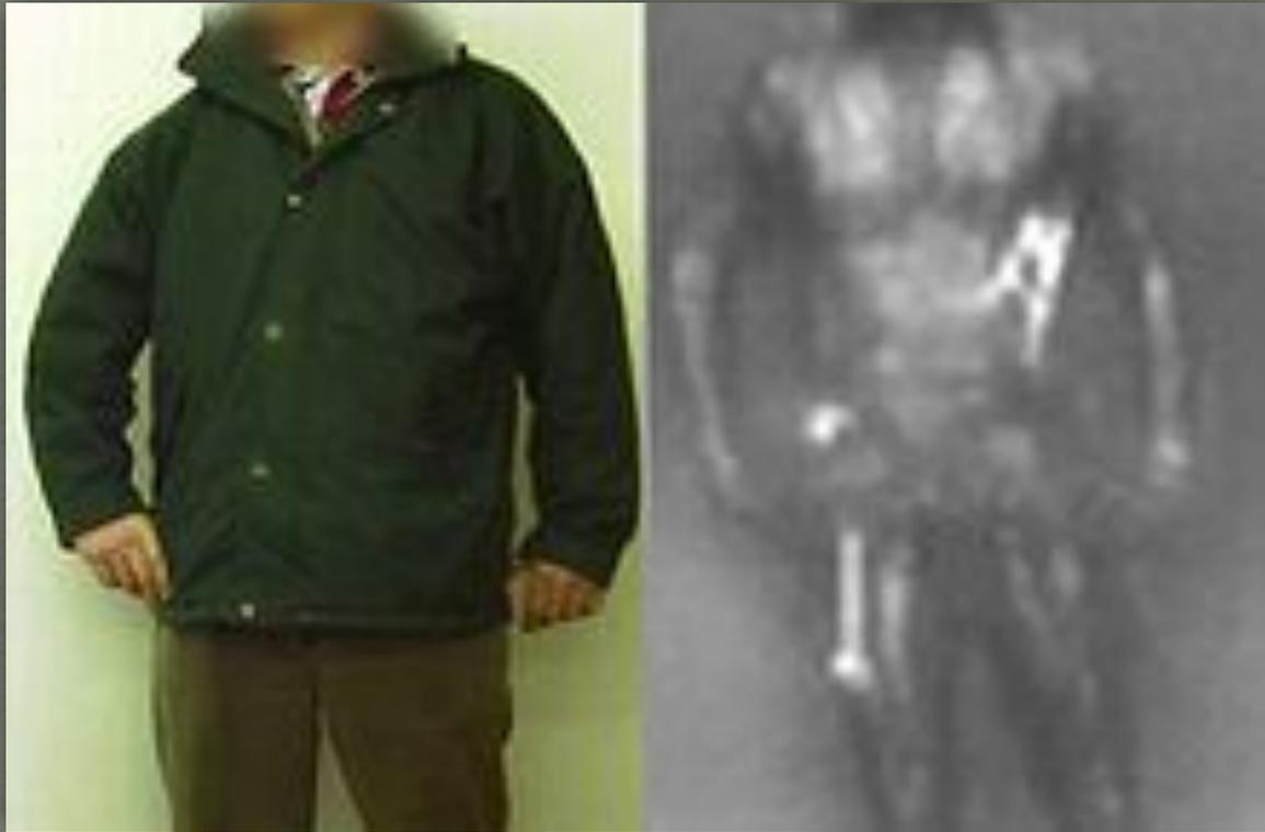
В системах безопасности используется ТГц (мм) излучение для сканирования багажа и людей.
