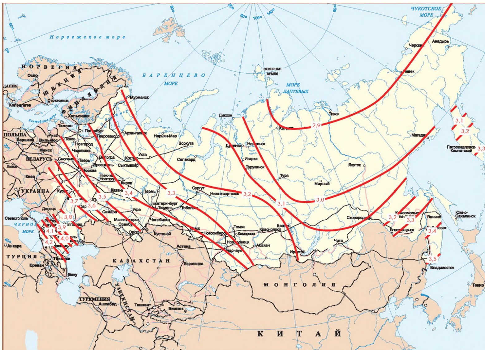
Рисунок Ж.1 — Районирование территории Российской Федерации по эффективности использования низкопотенциальной тепловой энергии для теплоснабжения. (Изолинии на карте — значения коэффициента трансформации энергии для «горизонтальных» ГТСТ, численно равные количеству полезной тепловой энергии, вырабатываемой ГТСТ на 1 кВт энергии, затрачиваемой на ее привод, в долях единицы)
