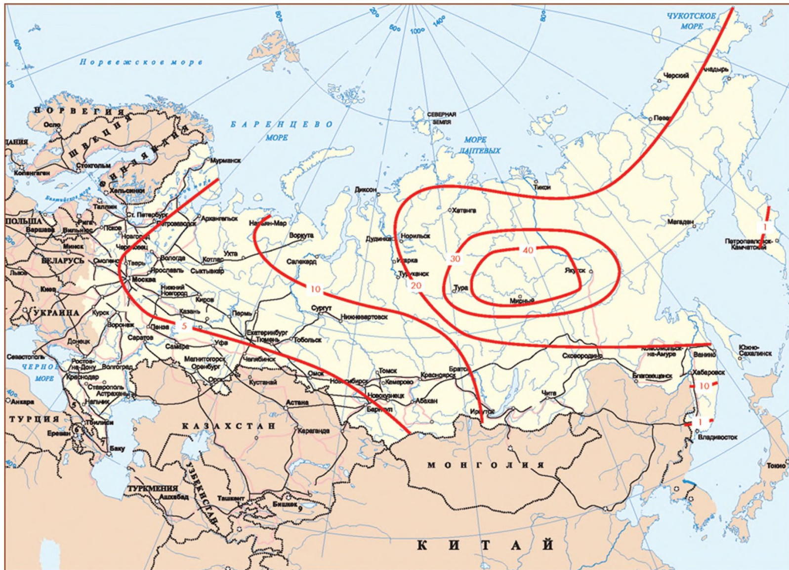
Рисунок Ж.7 — Районирование территории Российской Федерации по эффективности использования низкопотенциальной тепловой энергии поверхностных слоев Земли для теплоснабжения. (Изолинии на карте — доля тепловой энергии, вырабатываемой в течение года ПД в суммарных годовых энергозатратах системы «горизонтальная» ГТСТ+ПД, %)
