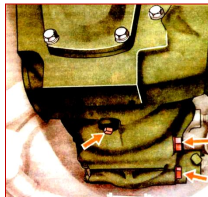
Масло из КПП авт. КамАЗ сливать через 3 отверстия: 2-КПП, 1- картер делителя
