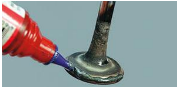
Нанесение притирочной пасты
