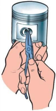
Снятие стопорного кольца поршневого пальца
