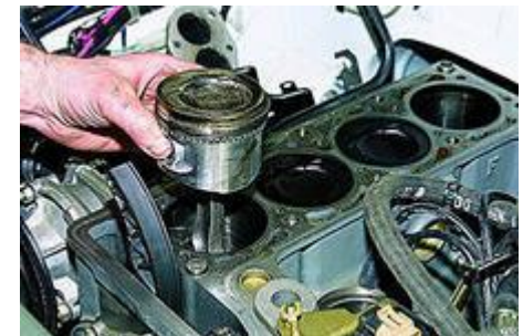
Извлечение поршня в сборе с шатуном.
