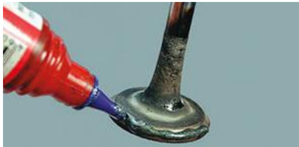
Нанесение притирочной пасты
