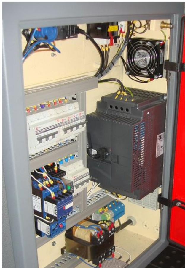
Станок 250 АТ.Ф1 оснащен электродвигателем повышенной мощности и частотным преобразователем.
