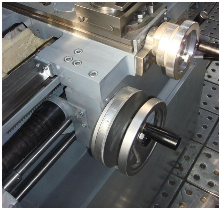
Ходовой винт токарного станка 250 АТ защищен специальной телескопической защитой.
