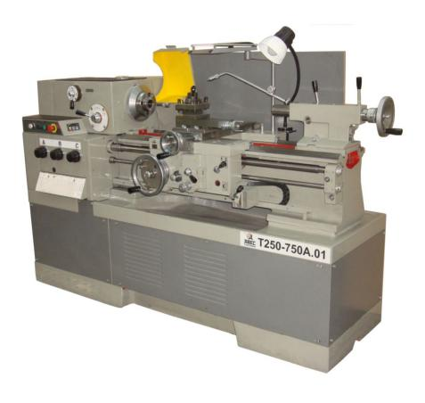
Токарно-винторезный станок Т250-750АТ.01
