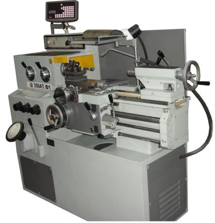
Токарно-винторезный станок 250 АТ.Ф1
