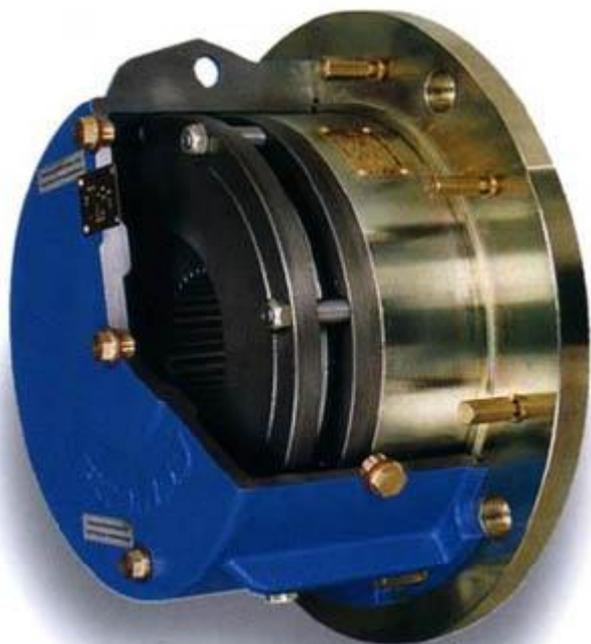
Сцепные муфты позволяют соединять и разъединять вращающиеся или неподвижные валы с помощью специальных механизмов управления. Из всего многообразия сцепных муфт наиболее широко распространены фрикционные дисковые и кулачковые муфты с электромагнитным и гидравлическим (пневматическим) управлением
