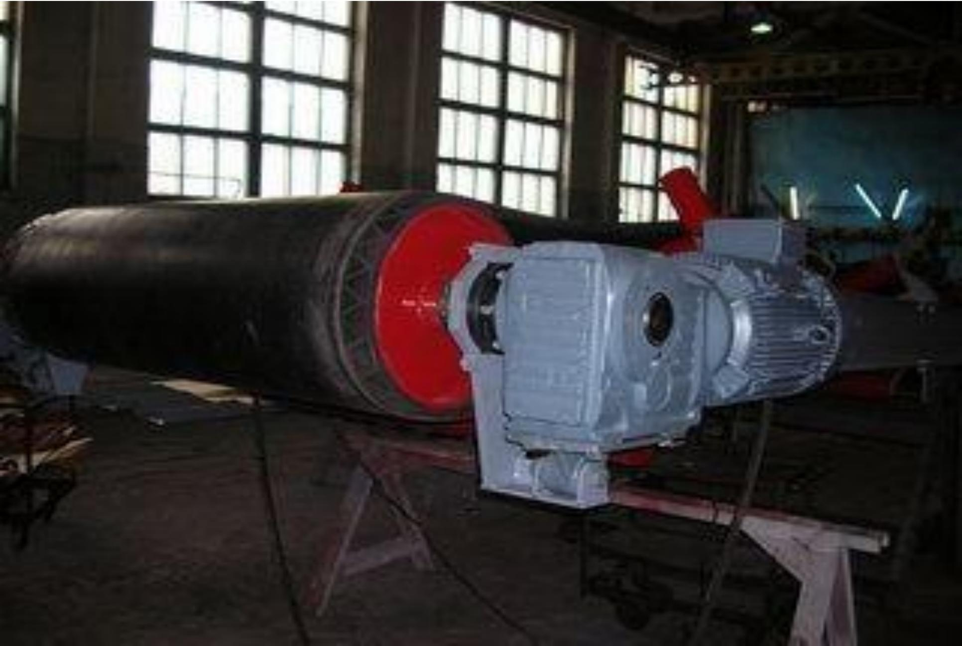
Мотор-барабаны выпускаются пяти типоразмеров (МБ1,6, МБ2, МБ3, МБ4, МБ5) мощностью от 0,37 до 15 кВт, номинальная скорость ленты от 0,25 до 3,55 м/сек.
