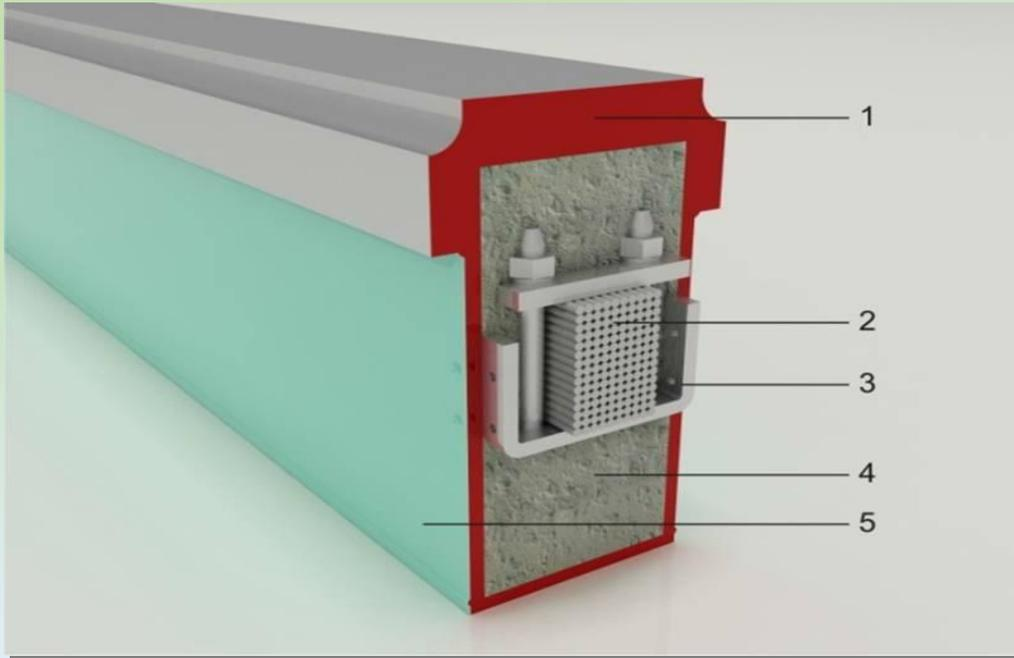
Струнные рельсы жёстко закреплены в анкерных опорах, установленных через 2—3 км и более одна от другой, и опираются на промежуточные опоры с образованием пролётов длиной 40—50 м и более.
