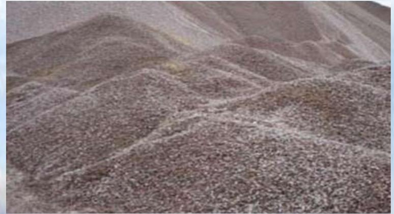
Материалы из отсевов дробления получают в виде песка, обогащенного песка, фракционированного песка, щебня и пылевидной составляющей (каменной муки).
