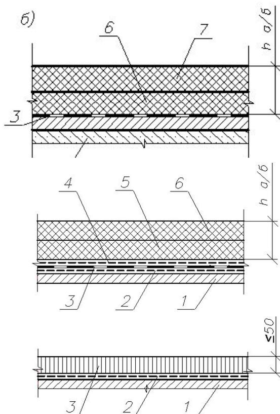
1 – железобетонная плита проезжей части; 2 – бетонный выравнивающий слой (может отсутствовать); 3 – гидроизоляция; 6 – нижний слой асфальтобетонного покрытия; 7 – верхний слой асфальтобетонного покрытия
