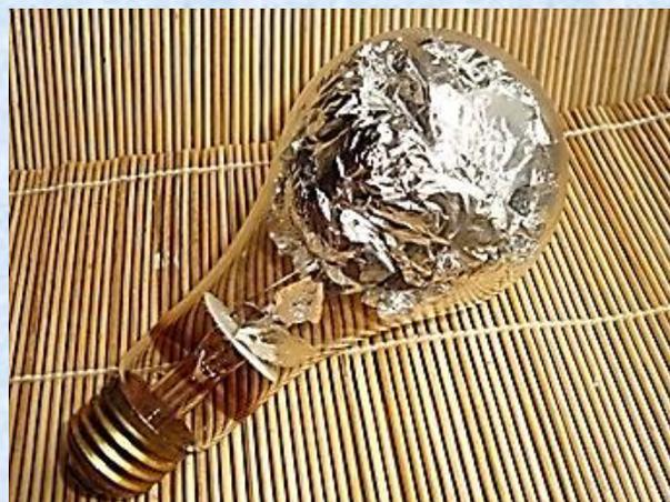
Длительность вспышки  $\Delta T$  определяется временем горения магния :  $\Delta T \sim 10^{-3}$  сек
