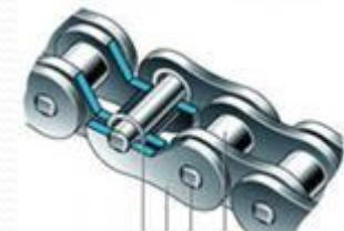
Широкое применение цепных передач началось с появлением втулочных и втулочно-роликовых цепей, обеспечивающих передачу мощности до 5000 кВт при высоких скоростях движения (до 35 м/сек), больших усилиях (до 700 Мн с несколькими параллельными контурами многорядных цепей)
