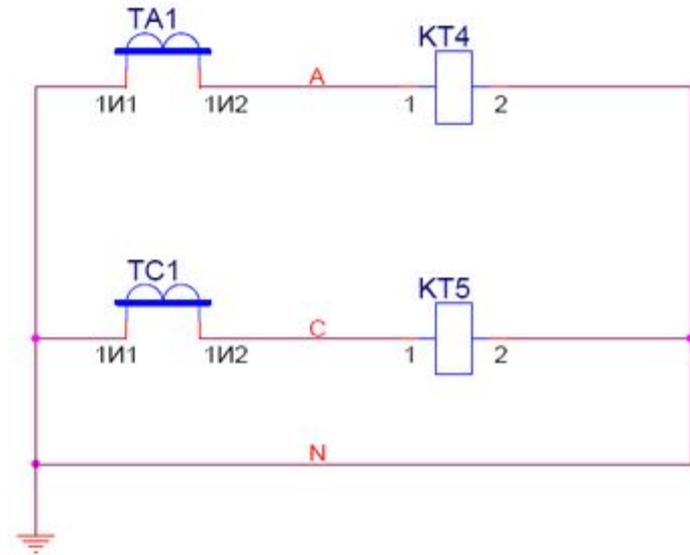
В трехфазных сетях с напряжением 6-10 кВ устанавливаются трансформаторы как во всех трех фазах, так и только в двух (А и С). В сетях с напряжением 35 кВ и выше трансформаторы тока в обязательном порядке устанавливаются во всех трех фазах.
