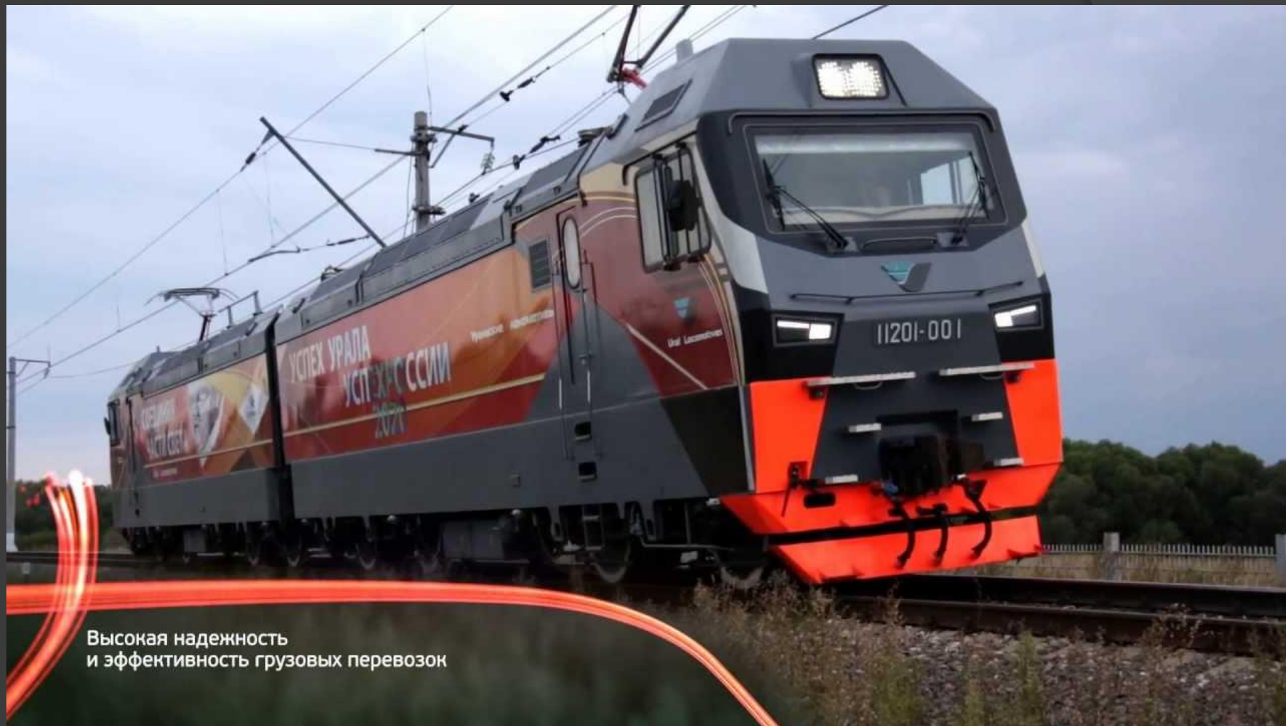
Рисунок 2- Грузовой электровоз переменного тока 2ЭС7 (11201) производства компании "Уральские локомотивы"
