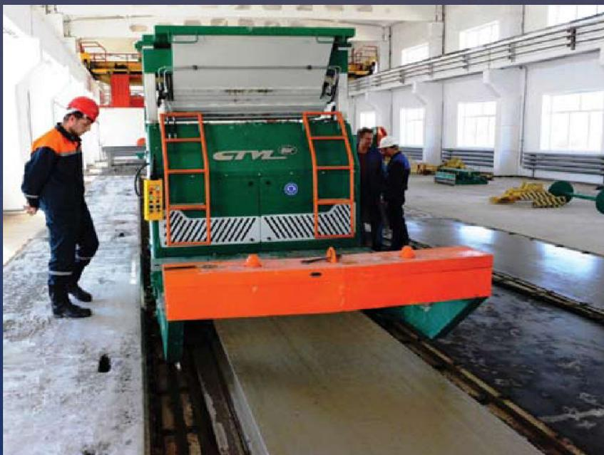
Виброформование плиты перекрытия шириной 1,5 м
