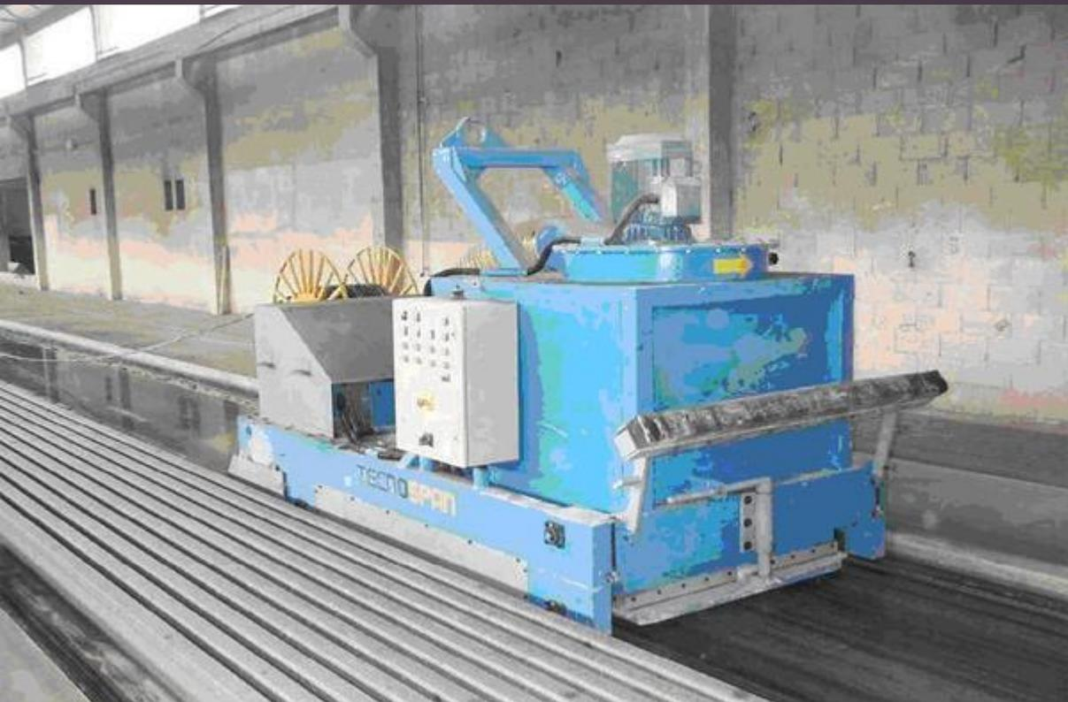
Чистка и смазка дорожки: средняя скорость чистки с помощью специальной машины — 6 м/мин. Время чистки — 15 минут. Смазка дорожки производится сразу же после чистки с помощью ранцевого насоса. Общее время всех операций — 30 мин.
