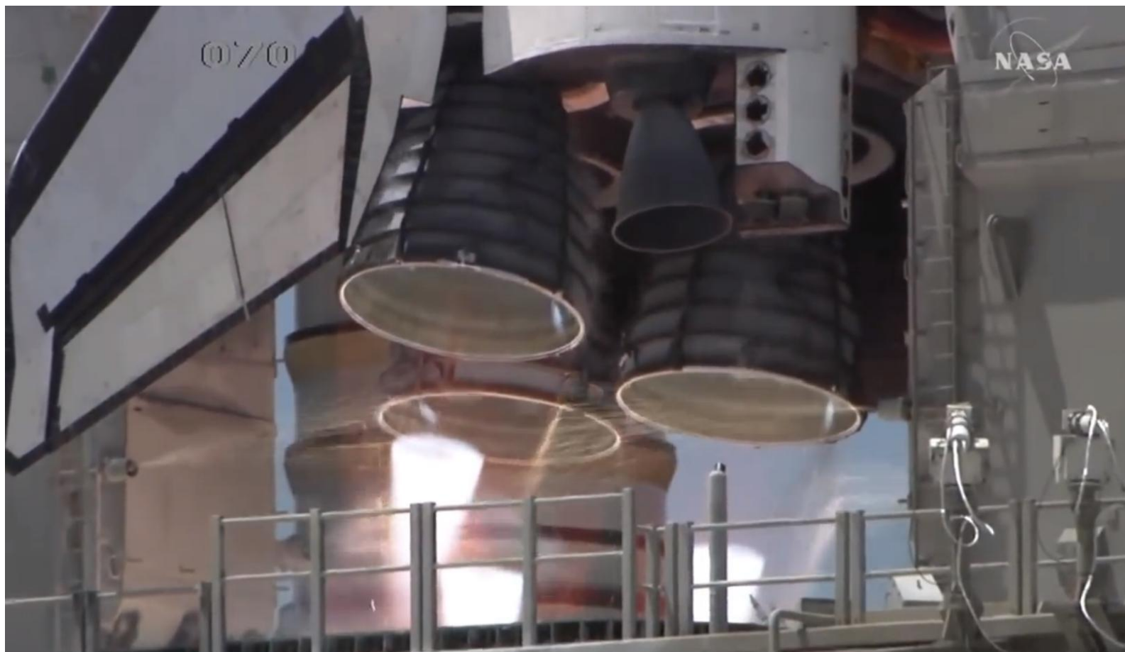
Space Shuttle: управляемый вектор тяги основных ЖРД
