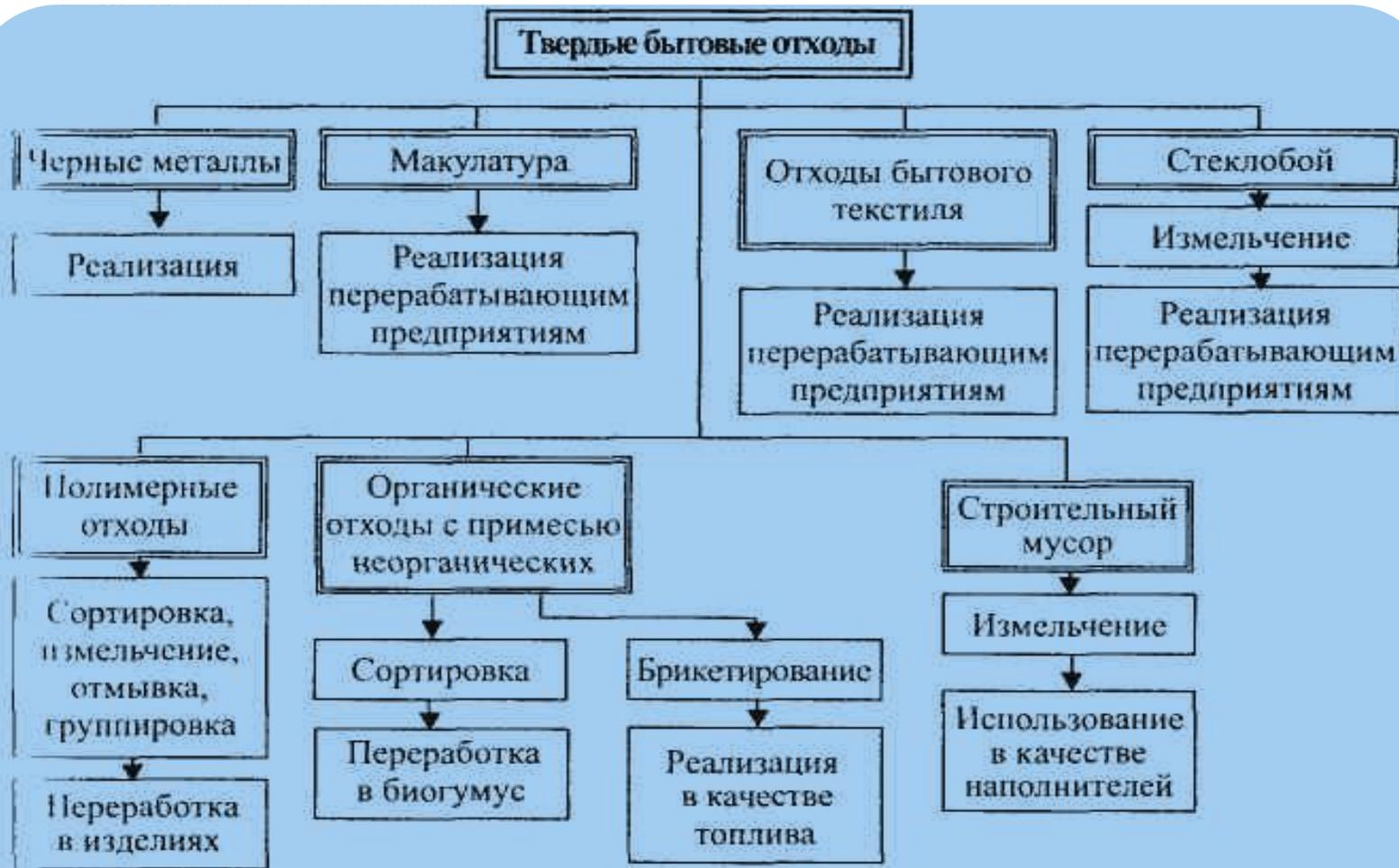
Рис. 6.6. Принципиальная схема сортировки отходов на мусороперегрузочной станции
