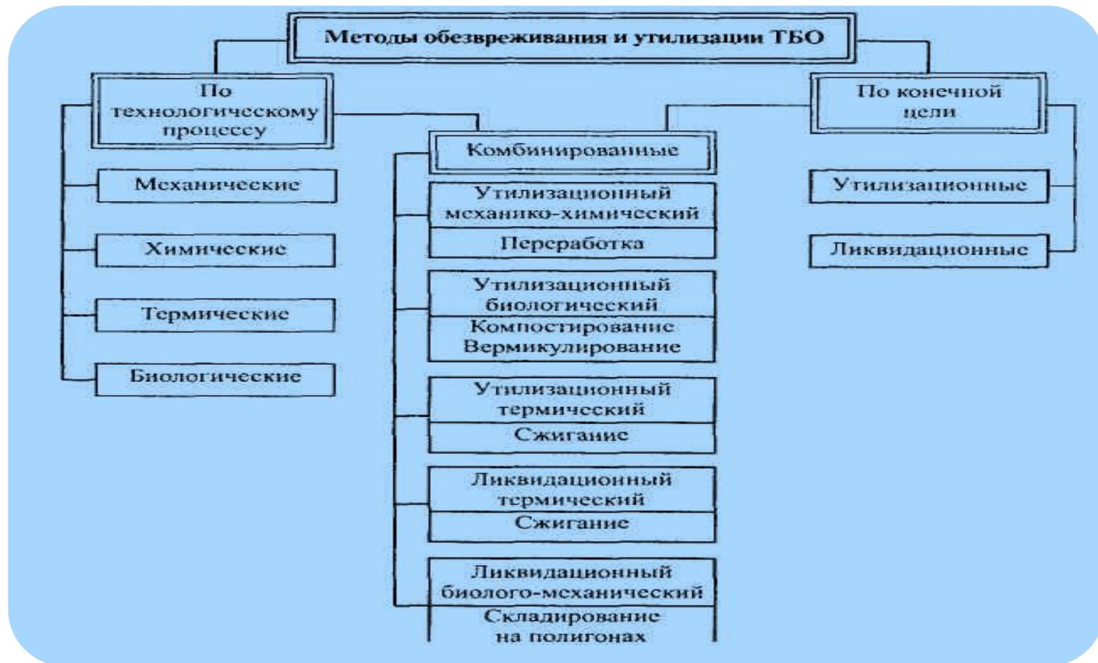
Рис. 6.7. Классификация технических методов обезвреживания и утилизации ТБО
