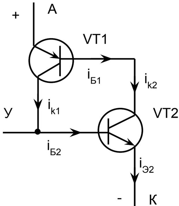
При небольшом напряжении анод-катод VT1 и VT2 закрыты.
